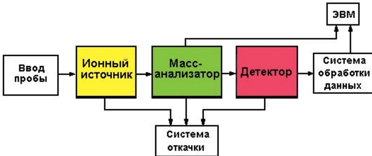
*Принципиальная схема масс-спектрометра – вакуумного прибора, использующего физические законы движения заряженных частиц в магнитных и электрических полях.*
