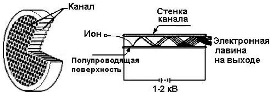
Схема многоканальной пластины (МКП, англ. MCP)
