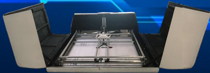
Базовая станция обслуживания БПЛА (автономная станция) БС-2
