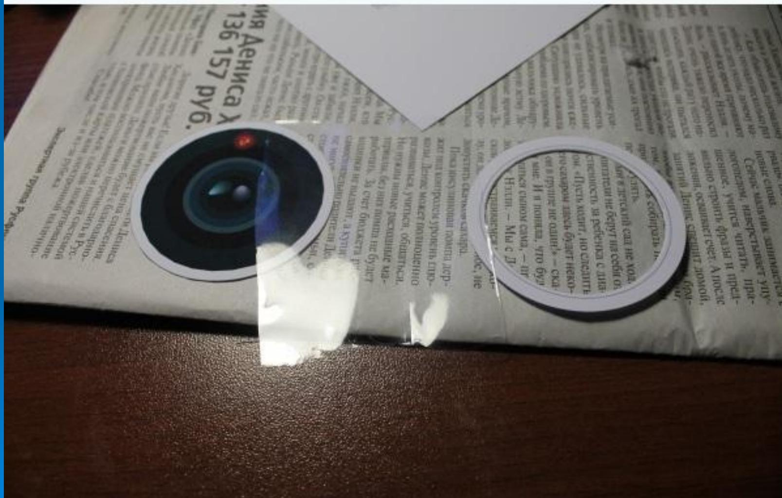
Аккуратно наносим клей по краю пленки. Получается "бутерброд"-деталь 17/13=>пленка=>деталь 15. Получается как на фото ниже.
