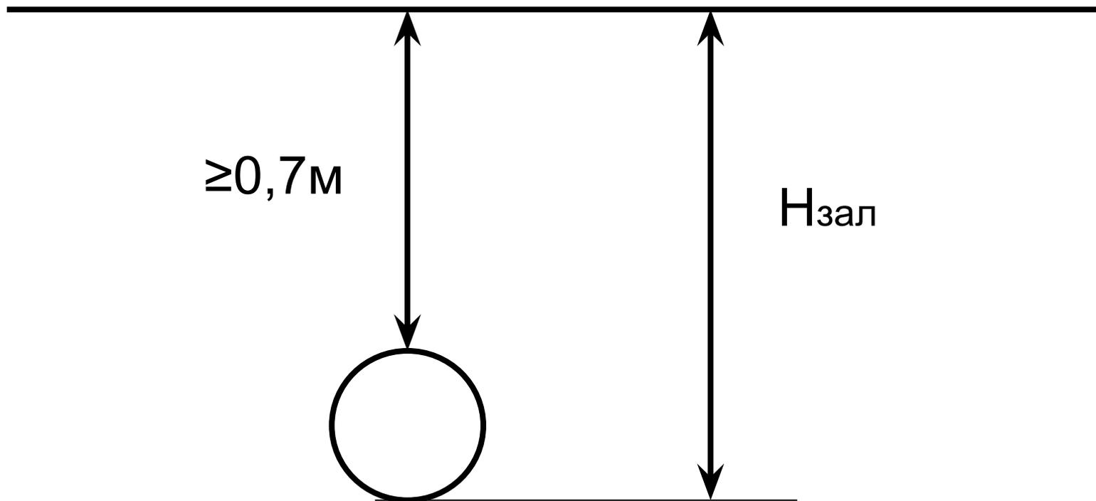
При  $D \leq 500\text{ мм}$   $H_{\text{зал}} = h_{\text{пром}} - 0,3\text{ м}$
