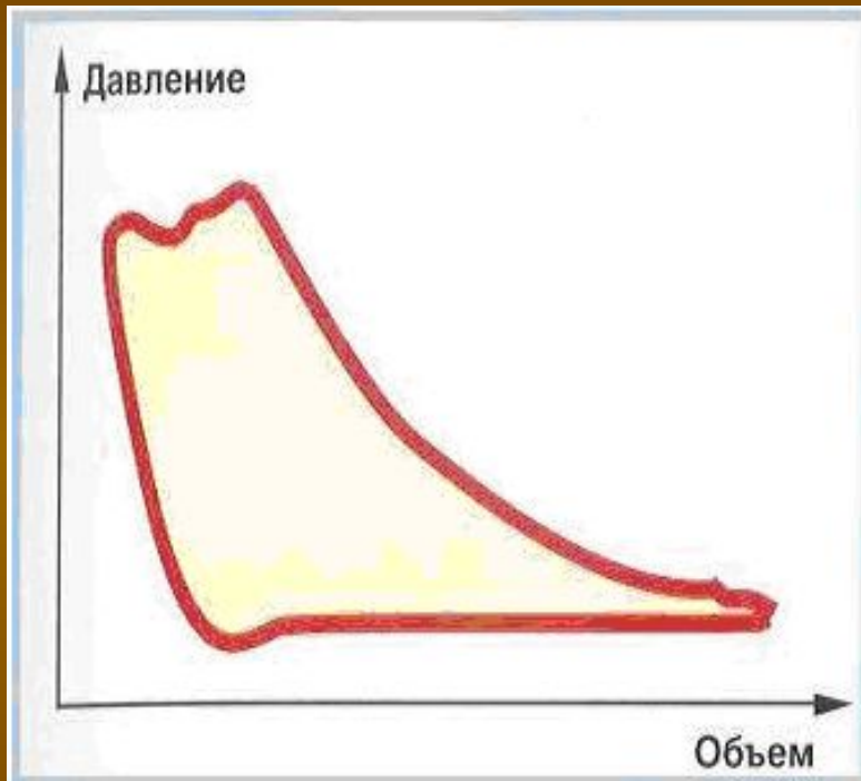
Рис 1. На рисунке схематично показан принцип работы поршневого компрессора с самодействующими клапанами. На графике p/V схематично показан процесс без учёта потерь, с полным заполнением и опустошением цилиндра.
