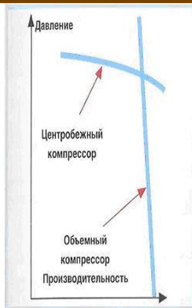
Рис.3. Вот так выглядят нагрузочные характеристики центробежного и объёмного компрессоров при изменяющейся нагрузке и постоянной скорости.
