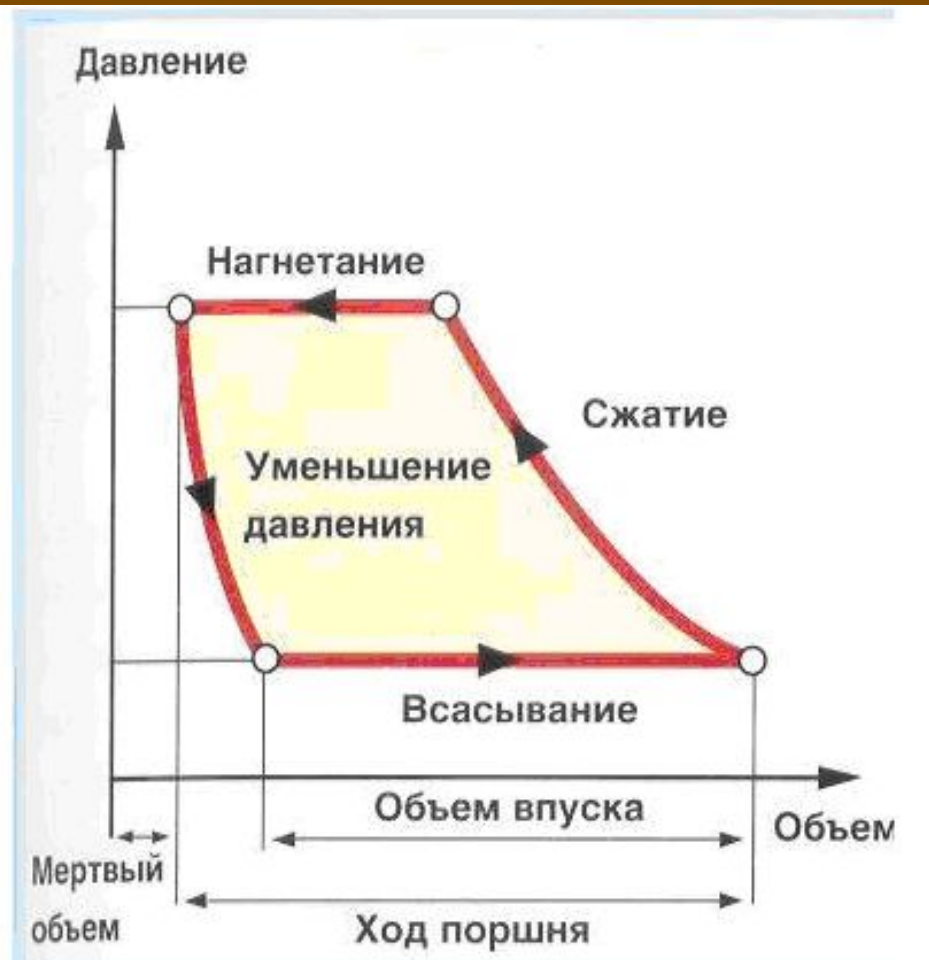
Рис 2. На рисунке схематично показан принцип работы поршневого компрессора с самодействующими клапанами. На графике p/V схематично показан процесс без учёта потерь, с полным заполнением и опустошением цилиндра.
