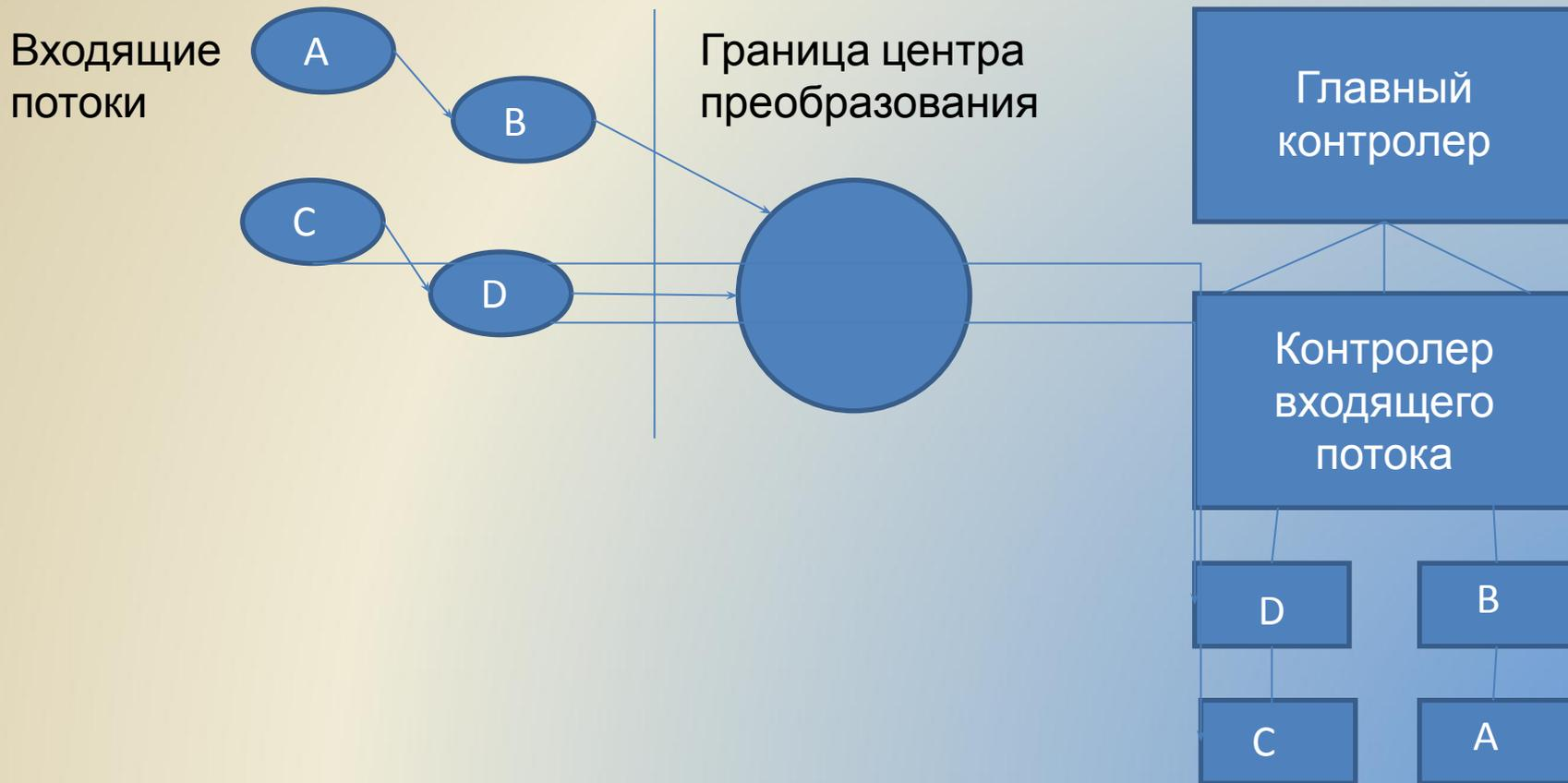
Центр преобразования ПДД отображается иначе. Каждый преобразователь отображается в модуль, непосредственно подчиненный контроллеру центра. Проходится преобразуемый поток слева направо.
