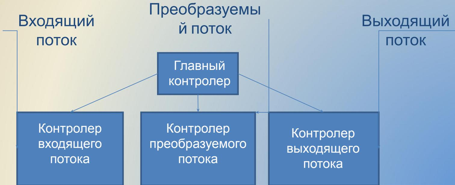
6. Детализация структуры ПС. Выполняется отображение преобразователей ПДД в модули структуры ПС. Отображение выполняется движением по ПДД от границ центра преобразования вдоль входящего и выходящего потоков. Входящий поток проходит от конца к началу, а выходящий поток — от начала к концу. В ходе движения преобразователи отображаются в модули подчиненных уровней структуры
