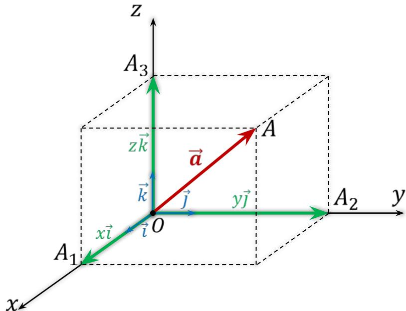
$$\vec{a} \{x; y; z\} \Rightarrow \vec{a} = x\vec{i} + y\vec{j} + z\vec{k}$$
