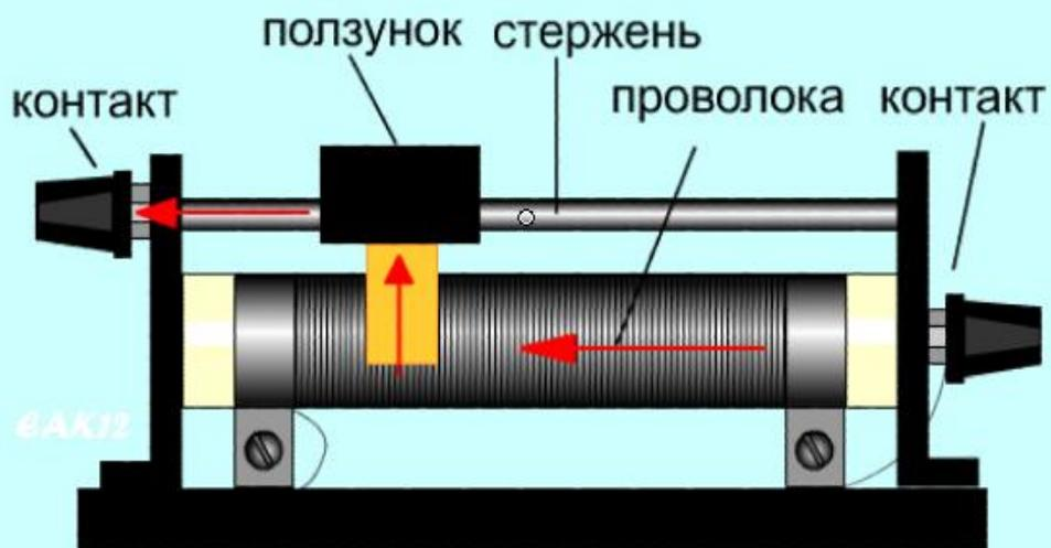
Стальная проволока намотана на керамический цилиндр. Проволока покрыта тонким слоем не проводящей окислы, поэтому её витки изолированы друг от друга. Над обмоткой расположен металлический стержень, по которому может перемещаться ползунок. Своими контактами он прижат к виткам обмотки.
