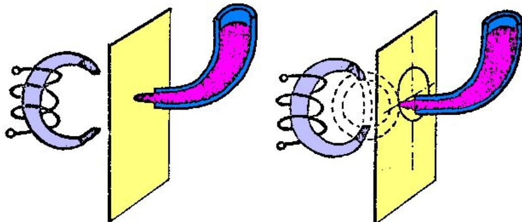
Изображение наносят с помощью магнитных чернил (смесь краски и ферромагнитного порошка), на которые воздействуют магнитным полем.
