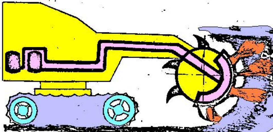
На роторе экскаватора установлены форсунки, позволяющие разогревать мерзлый грунт непосредственно во время работы роторного экскаватора.
