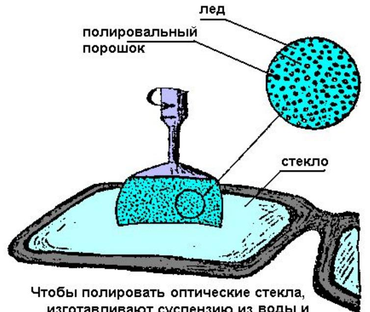
Чтобы полировать оптические стекла, изготавливают суспензию из воды и полировального порошка и замораживают в форме, которую имеет обрабатываемая поверхность.
