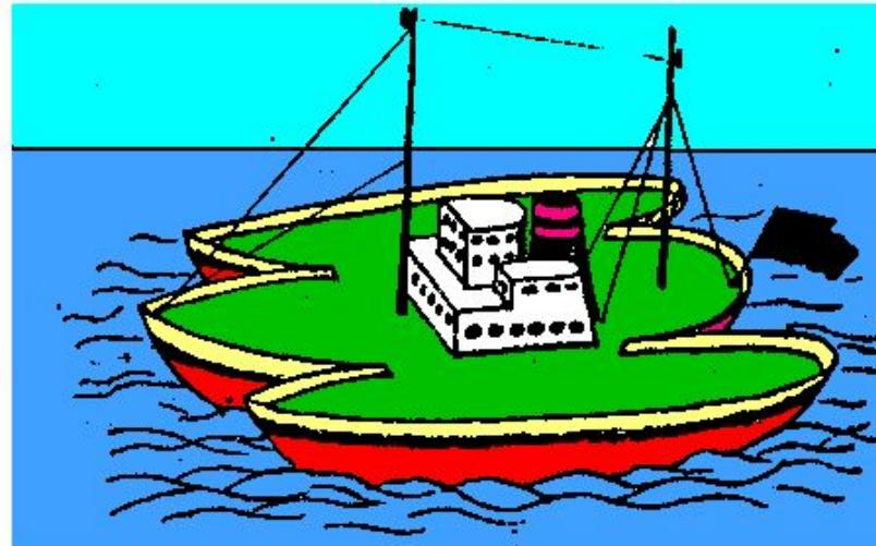
Трехкорпусное судно. Интерференция волн между корпусами уменьшает сопротивление воды движению судна
