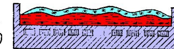
Способ изготовления листового полированного стекла путем отливки стекломассы на поверхность расплавленного металла. С целью получения профилированного стекла поверхности металла придают нужную форму с помощью бегущего электромагнитного поля.
