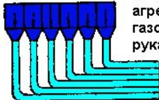
Поворотный участок газохода большого сечения (например, для котельных агрегатов) для равномерного распределения газового потока разделяют на несколько рукавов малого сечения
