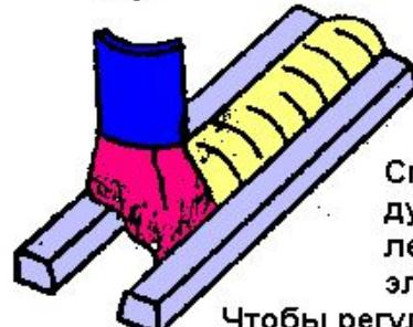
Способ дуговой сварки ленточным электродом.
