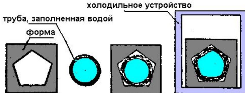
Формование металлических поверхностей путем замораживания находящейся под давлением воды
