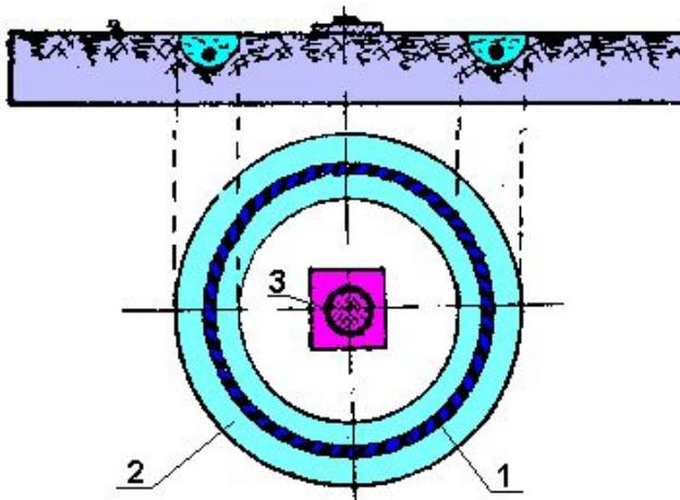
При открытых взрывных работах одновременно с подрывом заряда создают тоже взрывным способом - водяную завесу. Предложено создавать эту завесу на 0,1-0,2 секунды раньше основного взрыва, что увеличивает эффективность завесы.
