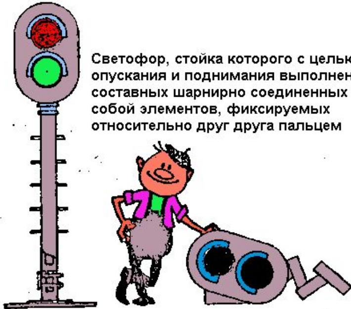
Светофор, стойка которого с целью быстрого опускания и поднимания выполнена из составных шарнирно соединенных между собой элементов, фиксируемых относительно друг друга пальцем
