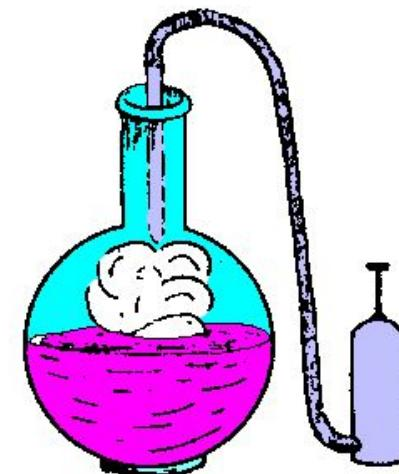
Способ подвода тепла в зону эндотермической реакции: вводят пары исходных продуктов, которые конденсируясь выделяют тепло, необходимое для реакции.
