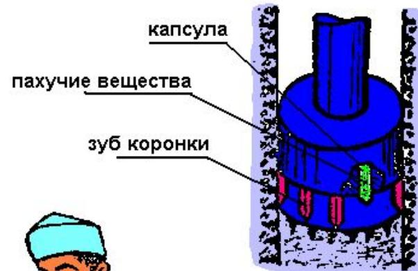
"Запаховый" способ контроля износа породоразрушающего инструмента
