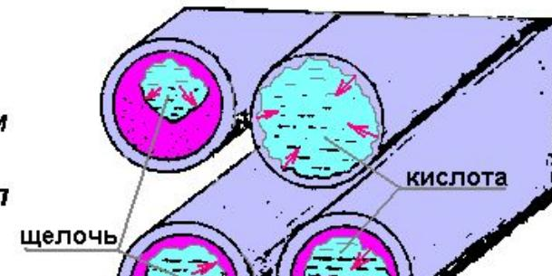
Если по трубам подавать щелочную жидкость, трубы застаются. Если подавать кислую жидкость, то кислота разъедает трубы. Предложено поочередно подавать по трубам то щелочную, то кислую жидкость. В результате кислота растворяет осадок, создаваемый щелочью
