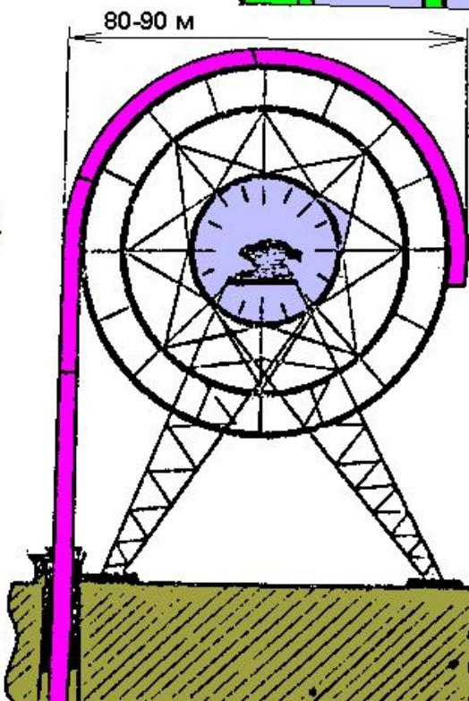
Проект бурового колеса. Такое колесо позволяет поднимать бурильную колонну не разворачивая, за счет изгиба труб. скорость спуско-подъемных операций увеличивается в 6 раз.
