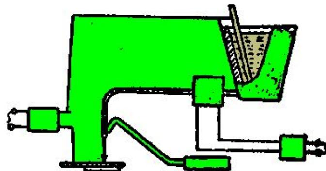
Способ дуговой сварки, при котором в качестве электрода используют струю жидкого металла, подаваемого электромагнитным насосом.
