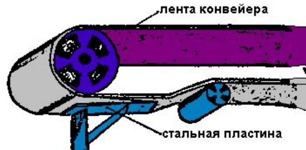
Скребки, очищающие ленточные конвейеры, быстро изнашиваются. Предложен вечный скребок: в зазор между лентой и стальной пластиной попадают частицы транспортируемого материала, они трутся о ленту, выполняя функцию вечно возобновляемого скребка.
