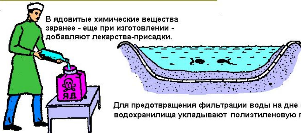
Для предотвращения фильтрации воды на дне строящегося водохранилища укладывают полиэтиленовую пленку
