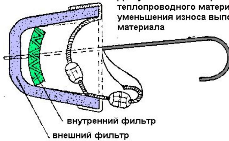
Противопылевой респиратор. Фильтрующая часть выполнена из двух пористых оболочек. Внешняя имеет более грубые поры и служит для предварительной очистки. Внутренняя оболочка с мелкими порами предназначена для окончательной тонкой очистки.
