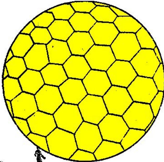
Спутник связи из проволоки. После вывода на орбиту включается устройство, надувашее шар. Принимая сферическую форму, шар расправляет проволочную сетку-антенну. Солнечные лучи разрушают поверхность шара и в космосе остается только антенна, предназначенная для отражения посыпаемых с земли радиоволн.
