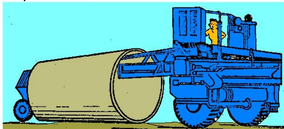
Машина для перевозки крупногабаритных железобетонных труб. Трубу не нужно грузить краном, трубовоз "пролезает" внутрь секции трубы, чуть-чуть приподнимает ее домкратами и в таком положении перевозит
