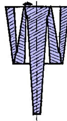
Ультразвуковой концентриатор выполнен в виде "матрешки", что позволяет уменьшить его длину.
