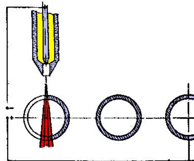
При плазменно-дуговой резке металла если невозможно наблюдать за процессом резки, то дугу создают "с избытком мощности", что гарантирует прорезание насеквось.
