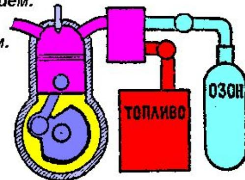
Для более полного окисления в двигателях внутреннего сгорания подводных лодок в качестве окислителя используют озон.
