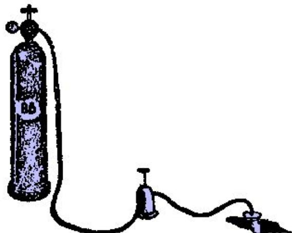
Способ возбуждения упругих волн в грунте. Взрывчатое вещество подается на заданную глубину в газообразном виде.
