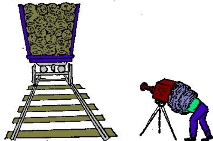
Способ обмера бревен, перевозимых на платформах: делают фотоснимки и ведут обмер по снимкам. Это в 50 раз быстрее, чем измерение самих бревен.
