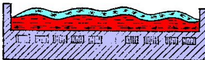
Способ изготовления листового полированного стекла путем отливки стекломассы на поверхность расплавленного металла. С целью получения профилированного стекла поверхности металла придают нужную форму с помощью бегущего электромагнитного поля.
