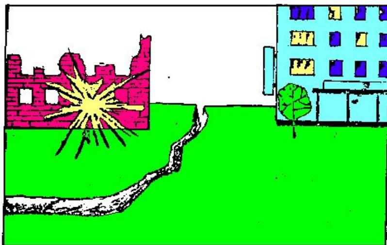
Как снести взрывом старый дом, чтобы не повредить стоящие рядом новые дома? Вырывают траншею, производят взрыв. Взрывная волна, достигнув траншеи, отражается и сама себя гасит.
