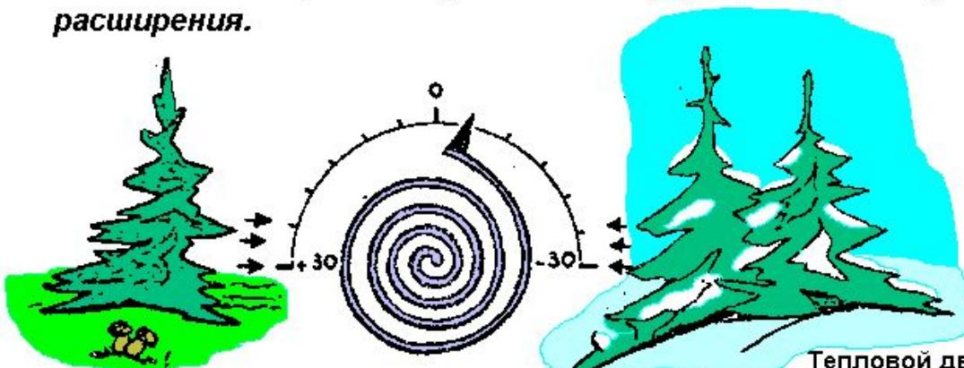
Применение биметаллической пластины в качестве термометра.
