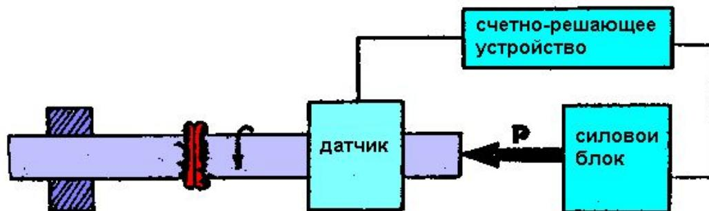
При сварке трением давление изменяют в зависимости от мгновенных значений коэффициента трения между свариваемыми поверхностями.
