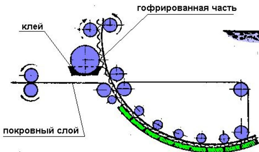
При изготовлении гофрированного картона гофрированную часть изгибают в сторону, противоположную приклеиваемому покровному материалу. При высыхании покровного материала из-за его усадки картон принимает плоскую форму.
