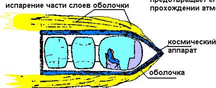
Испарение части слоев оболочки космического аппарата предотвращает его перегрев при прохождении атмосферы.
