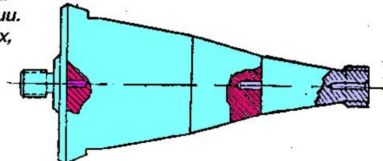
Устройство для ультразвуковой обработки отверстий. Для уменьшения нагрева средняя часть выполнена из теплопроводного материала. А концевые части для уменьшения износа выполнены из износостойкого материала
