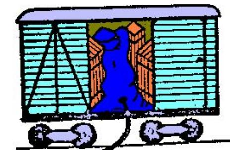
Грузы закрепляются с помощью пневматических зажимов
