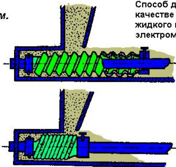
Дозатор сыпучих материалов. Шнек выполнен из эластичного материала с пружинной спиралью. Это позволяет регулировать шаг шнека.
