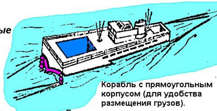
Корабль с прямоугольным корпусом (для удобства размещения грузов). Вместо носа и кормы - струи воды, обеспечивающие обтекаемость.
