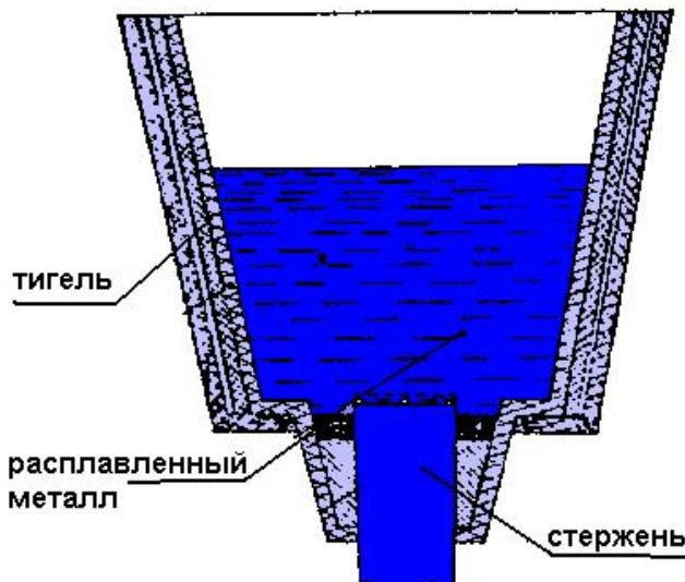
Стержень вибратора, передающий расплавленному металлу ультразвуковые колебания, постепенно разрушается. Чтобы частицы стержня не загрязняли расплав, стержень делают из того же материала, что и расплав.
