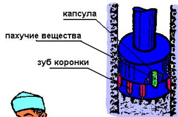
"Запаховый" способ контроля износа породоразрушающего инструмента
