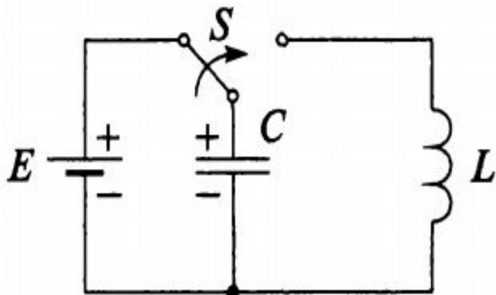
Заряженный конденсатор замкнуть на идеальную катушку с помощью ключа  $S$ . Конденсатор будет разряжаться, и энергия его электрического поля перейдет в энергию магнитного поля катушки, т.е. в магнитном поле накопится энергия
