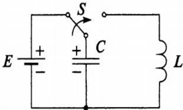
В замкнутом контуре, состоящем из индуктивности и емкости, происходят периодические колебания энергии между электрическим и магнитным полем - такой контур называется *колебательным*.
