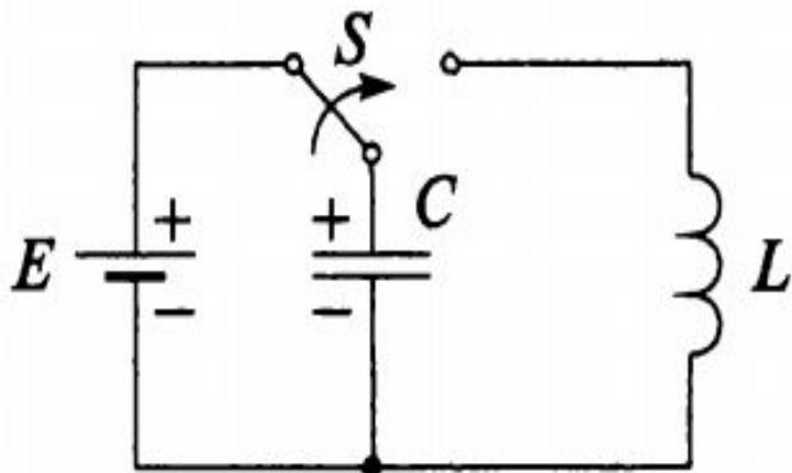
Если конденсатор предварительно зарядить от источника постоянного напряжения, то в электрическом поле конденсатора накопится энергия
