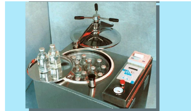
Стерилизатор паровой с вертикальной камерой
