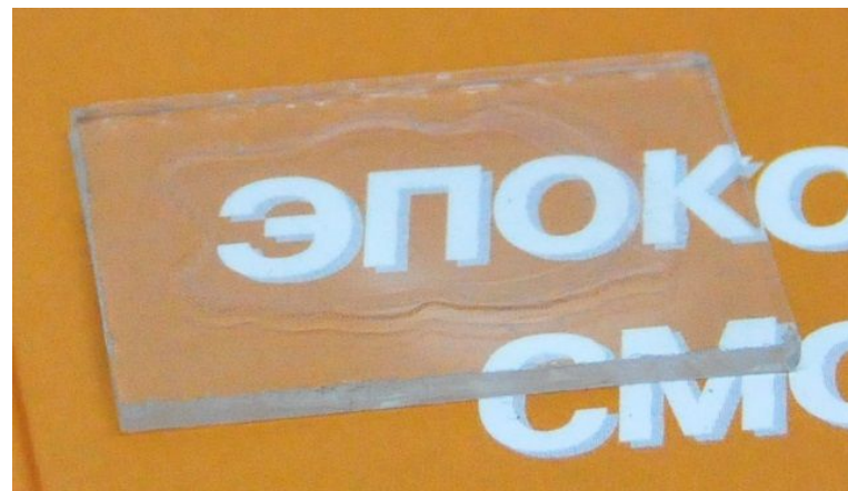
Внешний вид покрытия на основе эпоксидной смолы марки Э-05К, модифицированной фторкремнийорганическим сополимером
