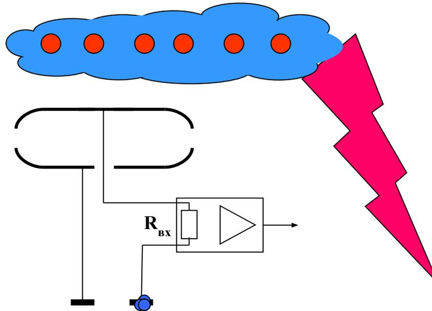
**Если в облаке появляются электрические заряды, на верхнюю пластину датчика с земли приходят заряды противоположного знака.**
