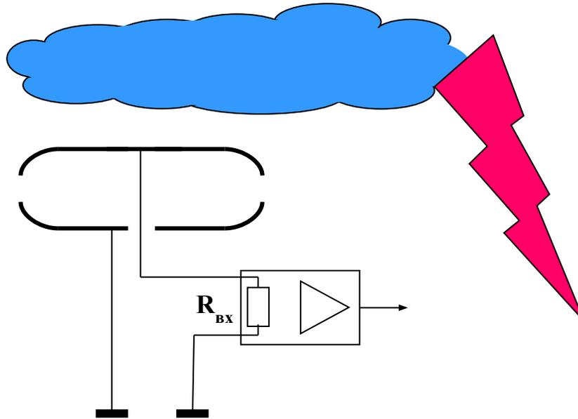
Рис. 8.4.1. Антенна датчика близких гроз.
