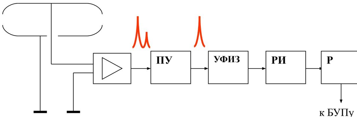
Рис. 8.4.2. Блок-схема датчика близких гроз КРАМС-2.
