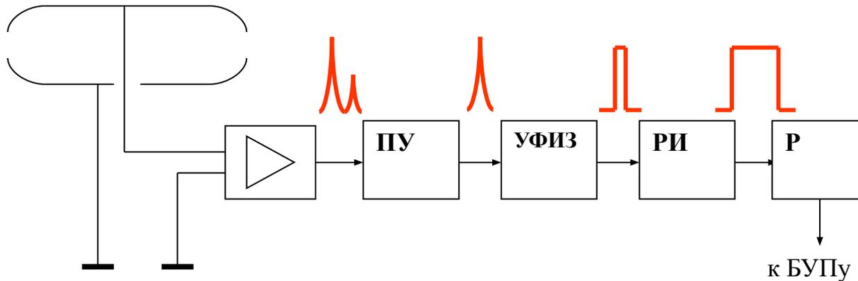
**Усилитель-формирователь импульсов запуска (УФИЗ)** генерирует прямоугольный импульс в ответ на поступающие молниевые импульсы.
