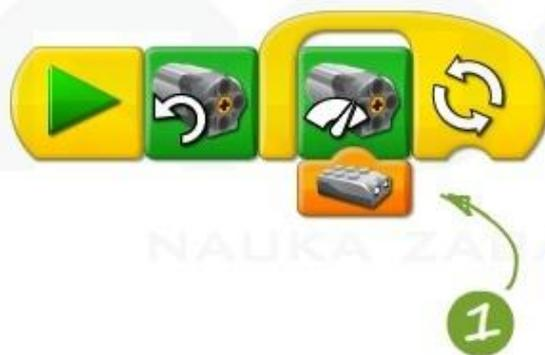
1. Устанавливаем скорость вращения мотора.
