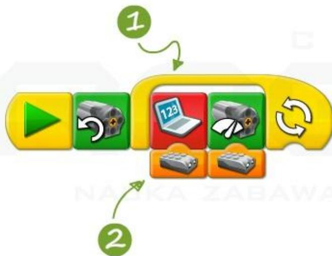
1. Теперь добавим еще одну команду: пусть скорость движения робота выводится на экран. Для этого возьмите красный блок с иконкой компьютера и поместите его внутрь цикла.
