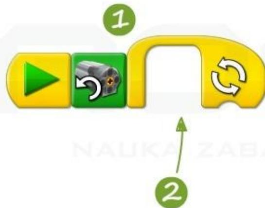
1. Теперь добавим "цикл", который будет повторять блок, отвечающий за скорость мотора.
