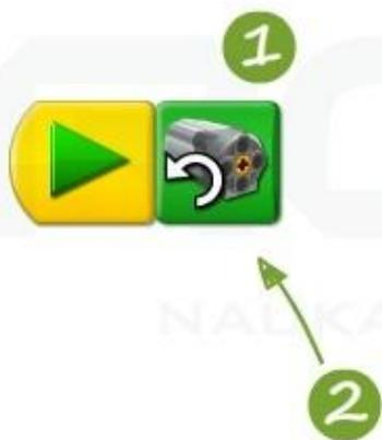
1. Добавим зеленый блок с иконкой мотора. Он запустит мотор и задаст направление движения .
