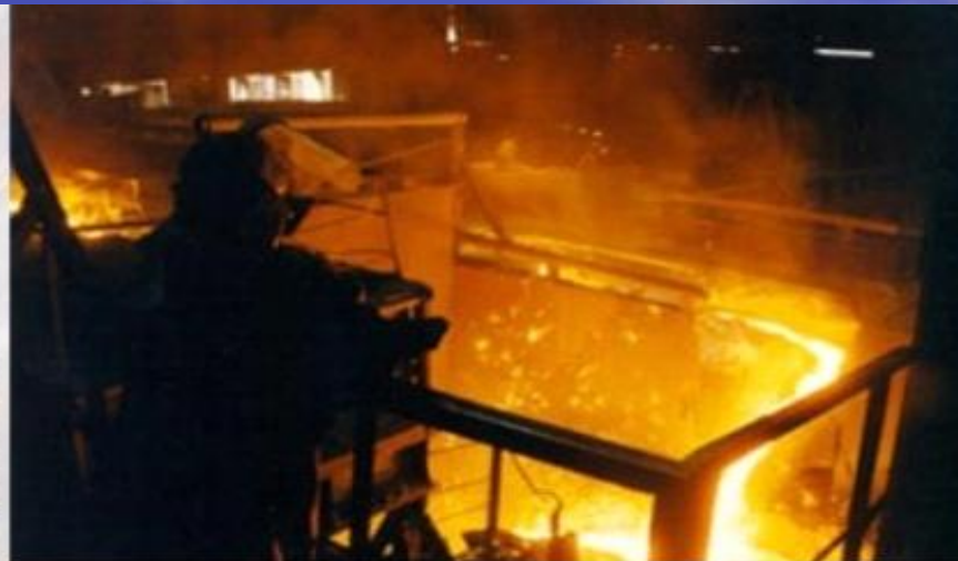
Разливка чугуна в изложницы.
