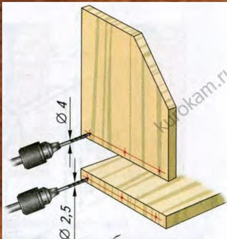
После этого в присоединяемой детали сверлят сквозное отверстие диаметром чуть большим, чем диаметр саморезов. Сверление выполняют на подкладной доске
