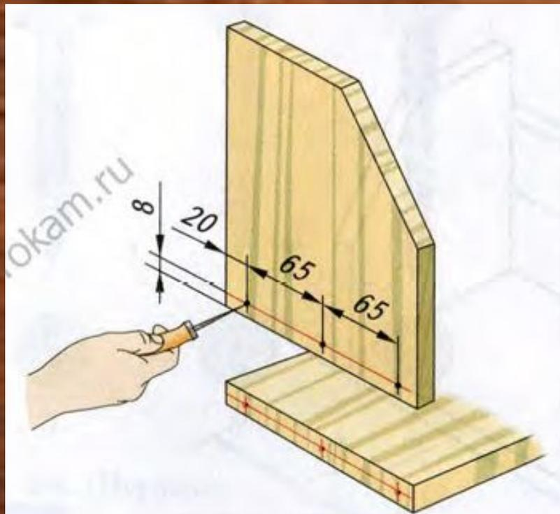
Перед соединением деталей на стенке и на торце основания размечают карандашом места расположения саморезов, шилом делают углубления в этих местах
