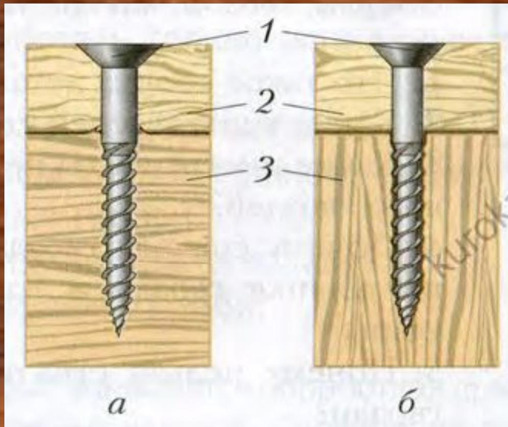
Соединение получается более прочным, если шуруп входит в основную деталь поперек волокон (а), и менее прочным – если вдоль волокон (б).
