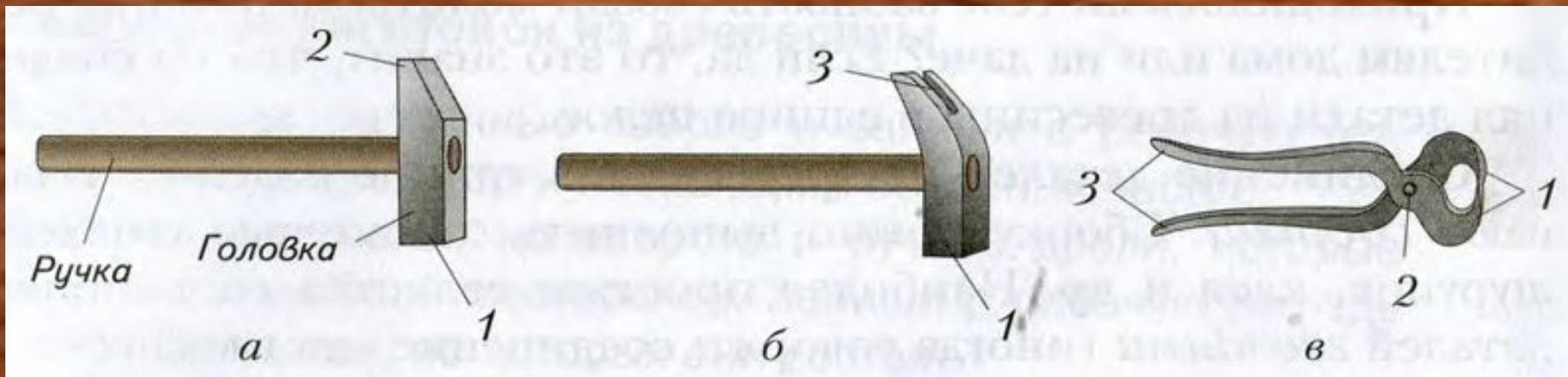
*а, б* – молотки: *1* – боёк; *2* – носок; *3* – прорезь для вытаскивания гвоздей;
