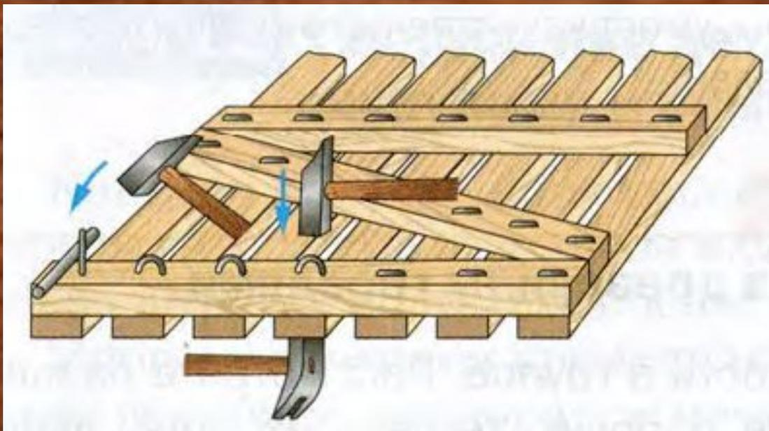
Чтобы при сборке повысить прочность изделия, выбивают гвозди, длина которых больше, чем длина двух соединяемых деталей, и пробивают деталь насквозь.
