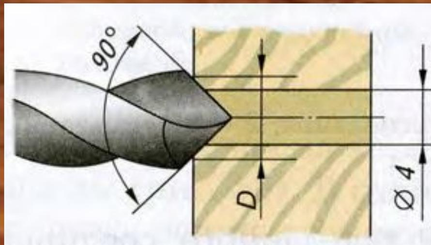
Для потайной головки самореза на входе сквозного в присоединяемой детали выполняют фаску сверлом большего диаметра, заточенным под углом  $90^\circ$
