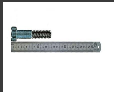
Замер длины болта линейкой
