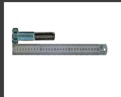
Замер длины болта линейкой
