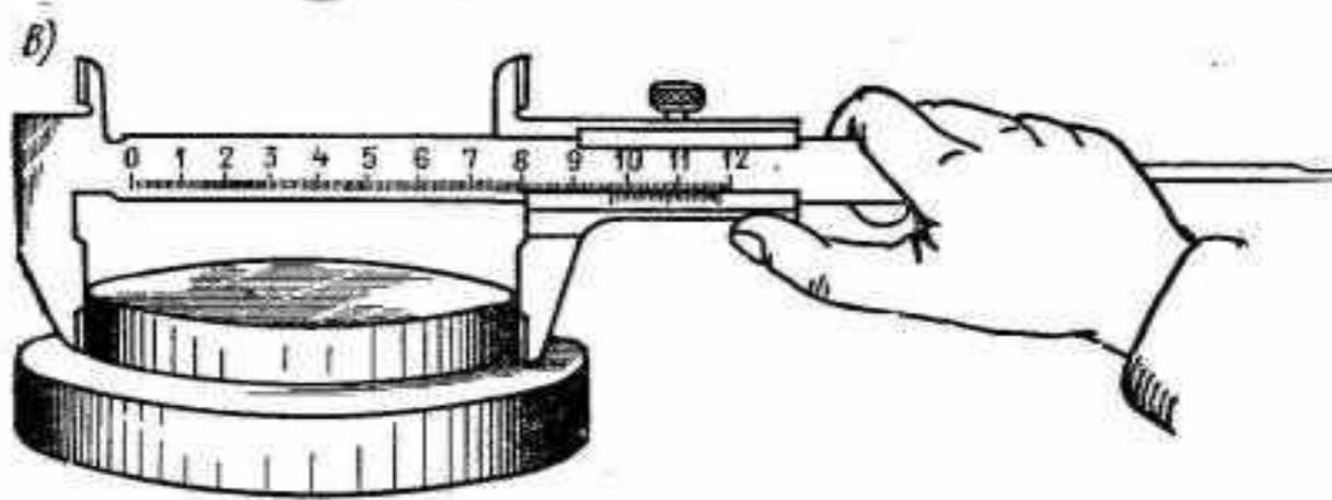
Рис. 89. Приемы измерений штангенциркулем: правильное измерение небольшого диаметра (*a*), неправильное (*б*) и правильное (*в*) измерение большого диаметра
