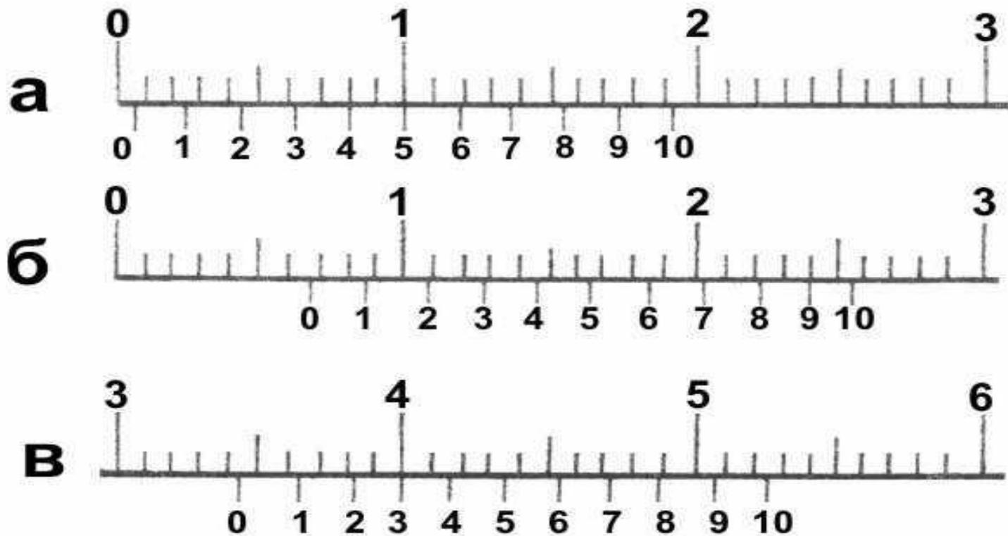
При измерении штангенциркулем целое число миллиметров отсчитывают по миллиметровой шкале до нулевого штриха нониуса, а десятые доли миллиметра — по шкале нониуса начиная от нулевой отметки до той риски, которая совпадает с какой-либо рисккой миллиметровой шкалы. На рисунке показаны положение шкал штангенциркуля при отсчёте размеров: а — 0,5 мм; б — 6,9 мм; в — 34,3 мм.
