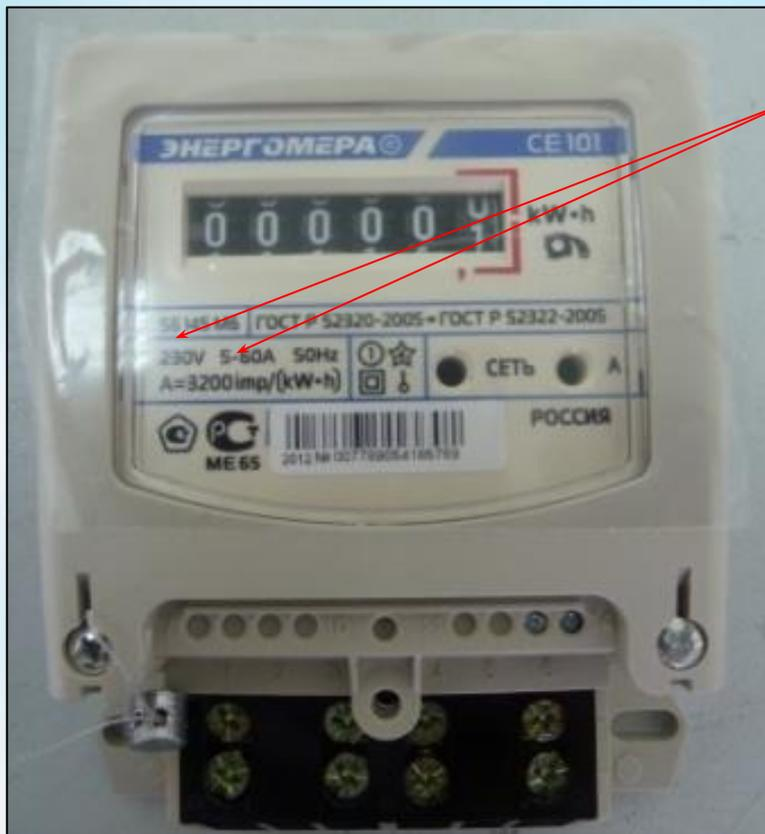
На лицевой панели счетчика видно, что счетчик с номинальным напряжением равным 230В и номинальным током равным 5А.
