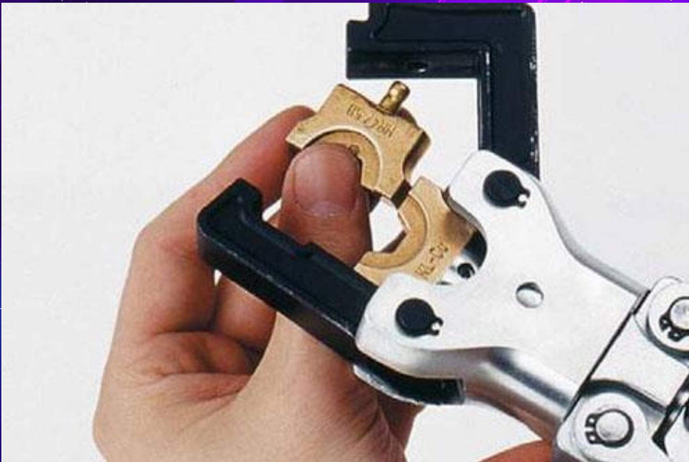
Кернение и вальцовка осуществляются за счет деформации деталей в месте соединения
