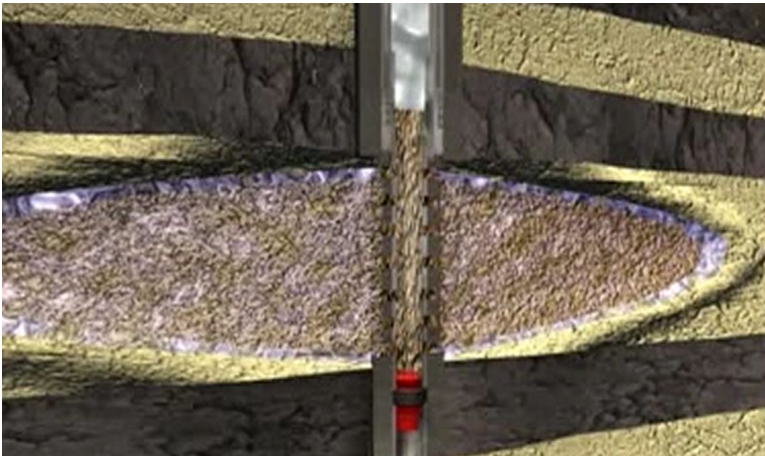
3. Дальнейшая продавка смеси проппанта в трещину
