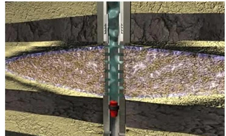
4. Промывка ствола скважины после фрэка
