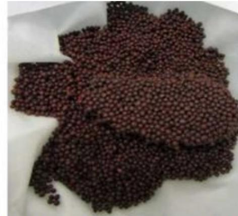
Внешний вид пропанта Fores 12/18 RCP через два часа экспозиции в реагенте Флаксокор 110 при пластовых температурах
