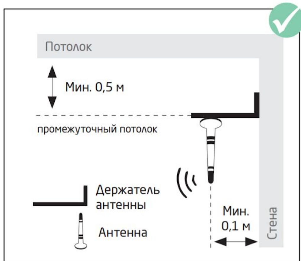
Рис. нр. 7 Правильная установка антенны под потолком
