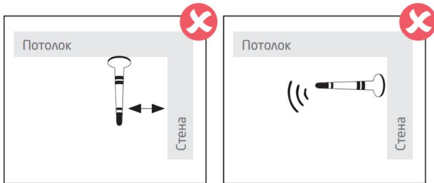
Рис. нр. 8 Неправильное крепление антенны под потолком
