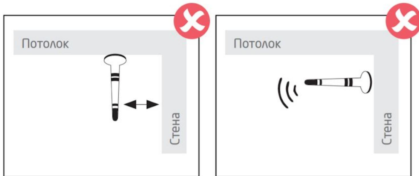
**Рис. нр. 8** Неправильное крепление антенны под потолком
