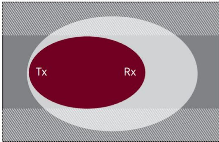
**Рис. нр. 1** Передача радиосигналов в форме эллипсоида
