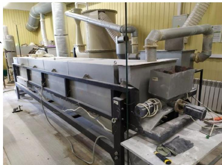
Рисунок 8. Аппарат для разложения титанового шлака
