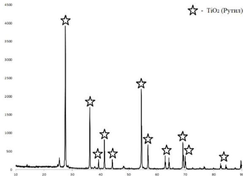
Рисунок 15. РФА диоксида титана, полученного по 9 эксперименту
