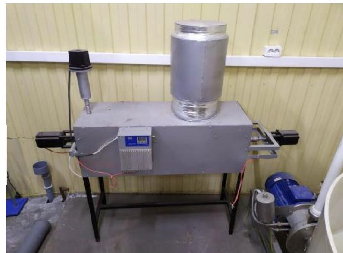
Рисунок 10. Шнековый сублиматор  $(\text{NH}_4)_2\text{SiF}_6$
