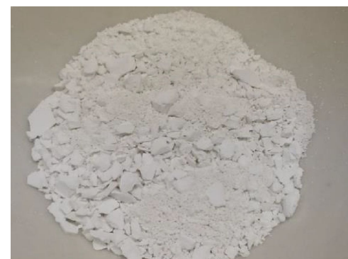
Рисунок 14. Высушенная титановая паста
