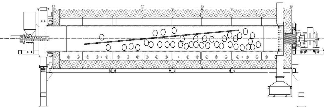
Рисунок 9. Барабанная вращающаяся печь фтораммонийного разложения титанового шлака
