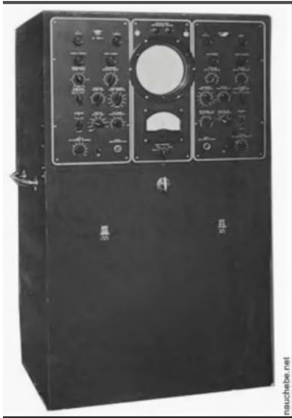
Двухканальный ДЭСО-1, полоса 60 МГц, 1956 год
