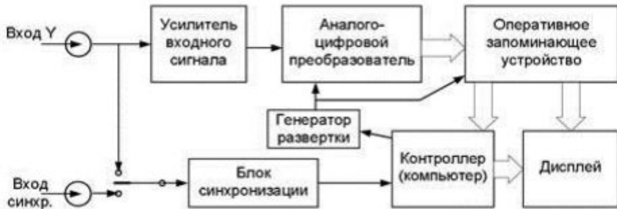
Упрощенная структурная схема цифрового осциллографа
