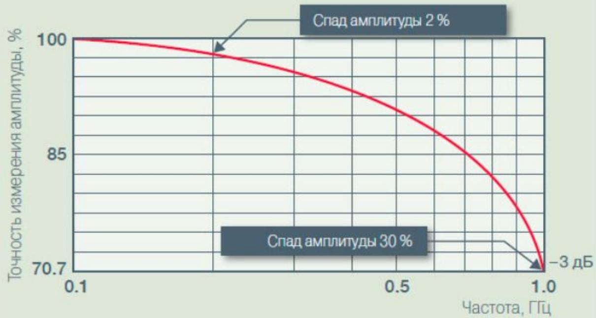
**Рис 1.** Полоса пропускания определяется как полоса частот, в пределах которой входной синусоидальный сигнал ослабляется осциллографом не более чем до **70,7 %** или по уровню **-3 дБ** (по уровню половинной мощности), как показано на данном рисунке для осциллографа с полосой пропускания 1 ГГц.
