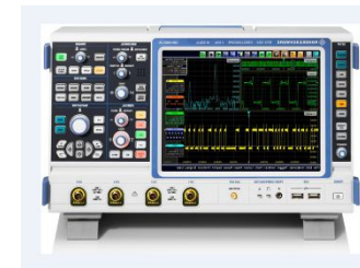
Современный RTO 1022 , полоса 2 ГГц, 2020 год
