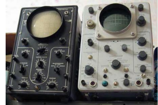
Заслуженные одноканальные «старички» ЭО-7 и С1-54
