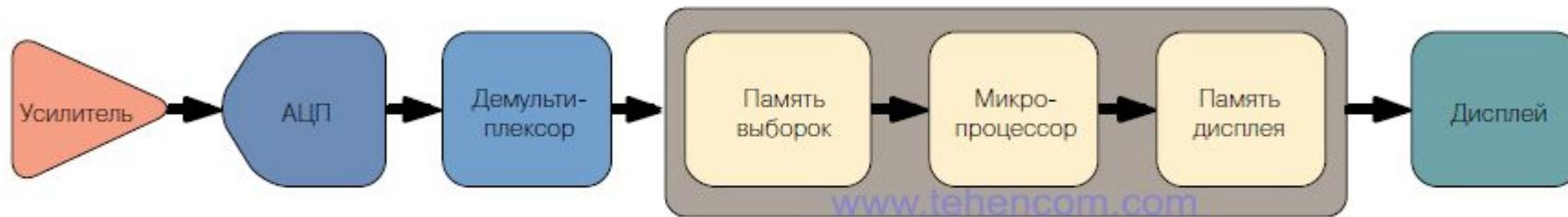
**Входной сигнал в цифровом запоминающем осциллографе DSO обрабатывается последовательно.**
