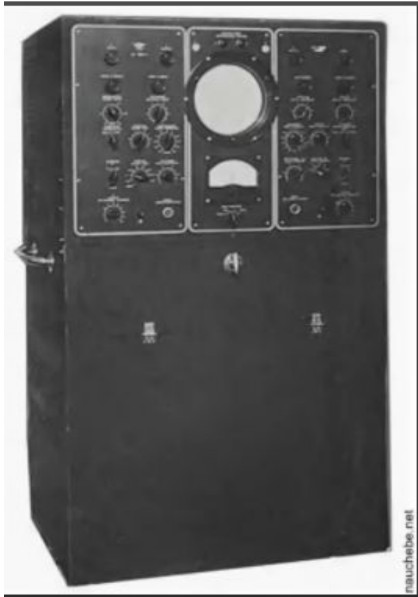
Двухканальный ДЭСО-1, полоса 60 МГц, 1956 год
