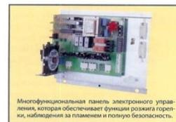
Многофункциональная панель электронного управления, которая обеспечивает функции розжига горелки, наблюдения за пламенем и полную безопасность.
