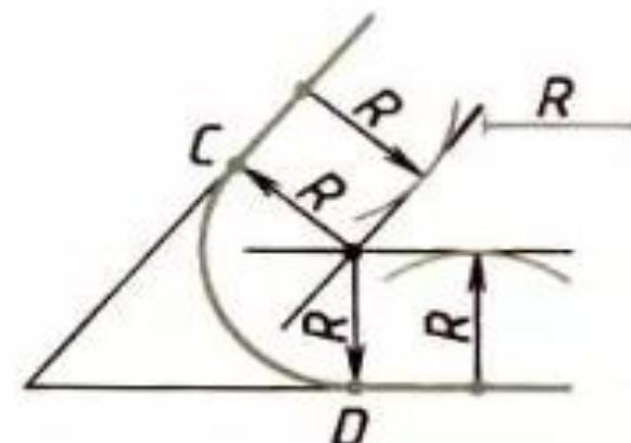
Сопряжение- это плавный переход одной линии (прямой или кривой) в другую линию (прямую или кривую).
