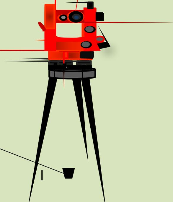
Затем теодолит переводится на вешку установленную на точке II и берется отсчет КЛ2.
