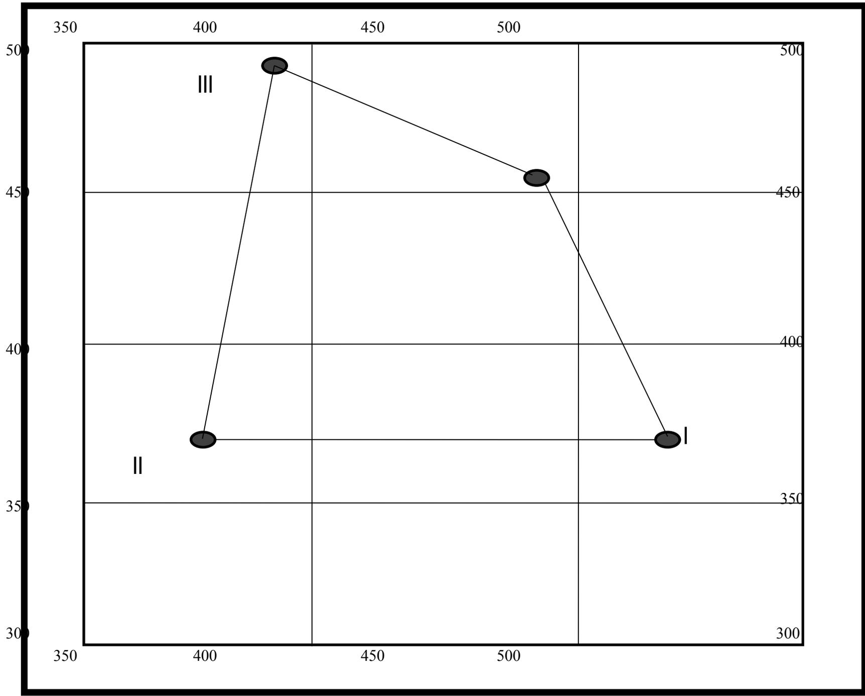
Проведя линии теодолитного хода приступаем к выносу результатов съемки подробностей, которые подробно разобраны в презентации «Построение теодолитного плана», там же отображено окончательное оформление плана теодолитной съемки.
