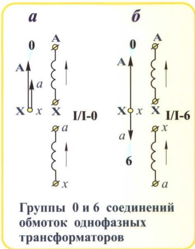
Группы 0 и 6 соединений обмоток однофазных трансформаторов
