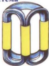
Пространственная стыковая магнитная система
