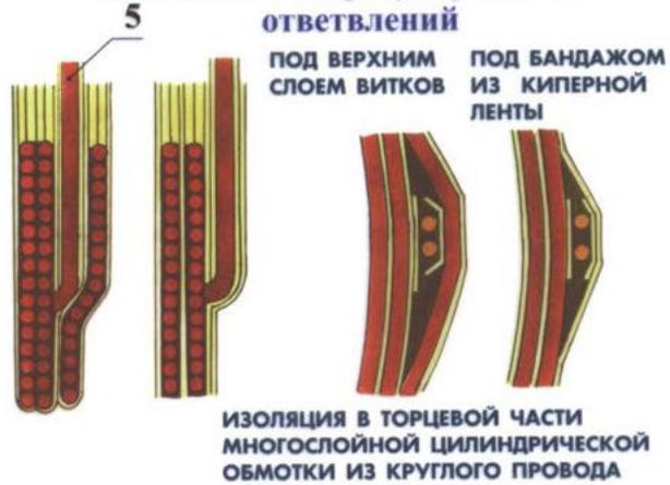
ИЗОЛЯЦИЯ В ТОРЦЕВОЙ ЧАСТИ МНОГОСЛОЙНОЙ ЦИЛИНДРИЧЕСКОЙ ОБМОТКИ ИЗ КРУГЛОГО ПРОВОДА
