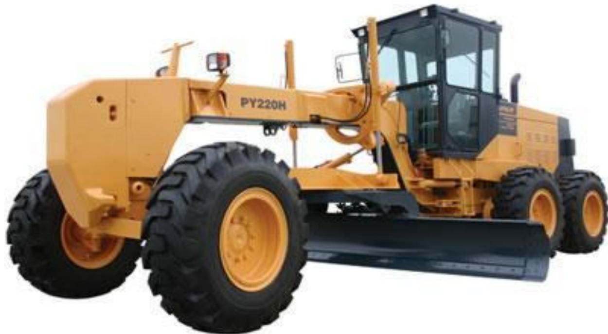
Выполнение всех функций грейдера происходит с помощью специального рабочего органа — отвала с ножом, который смонтирован на раме машины. Его можно поднимать, опускать, поворачивать в горизонтальной и вертикальной плоскости.
