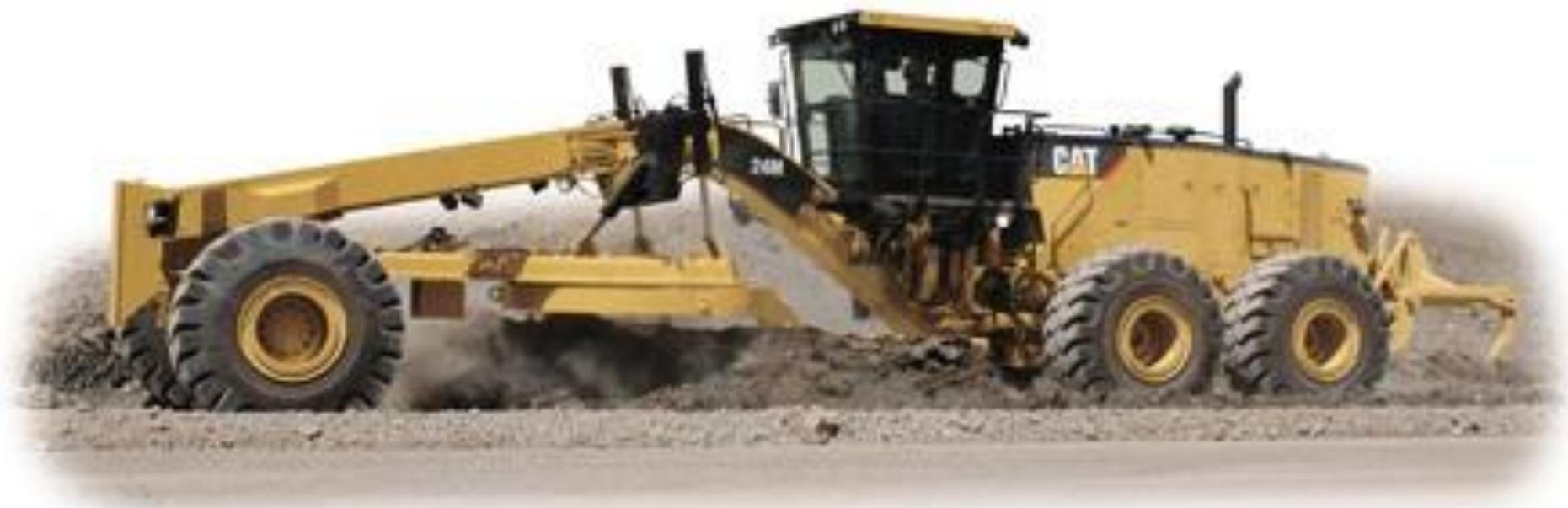
Грейдер-прицепная или самоходная машина для планировки и профилирования площадей и откосов, разравнивания и перемещения грунта, снега или сыпучих строительных материалов.
