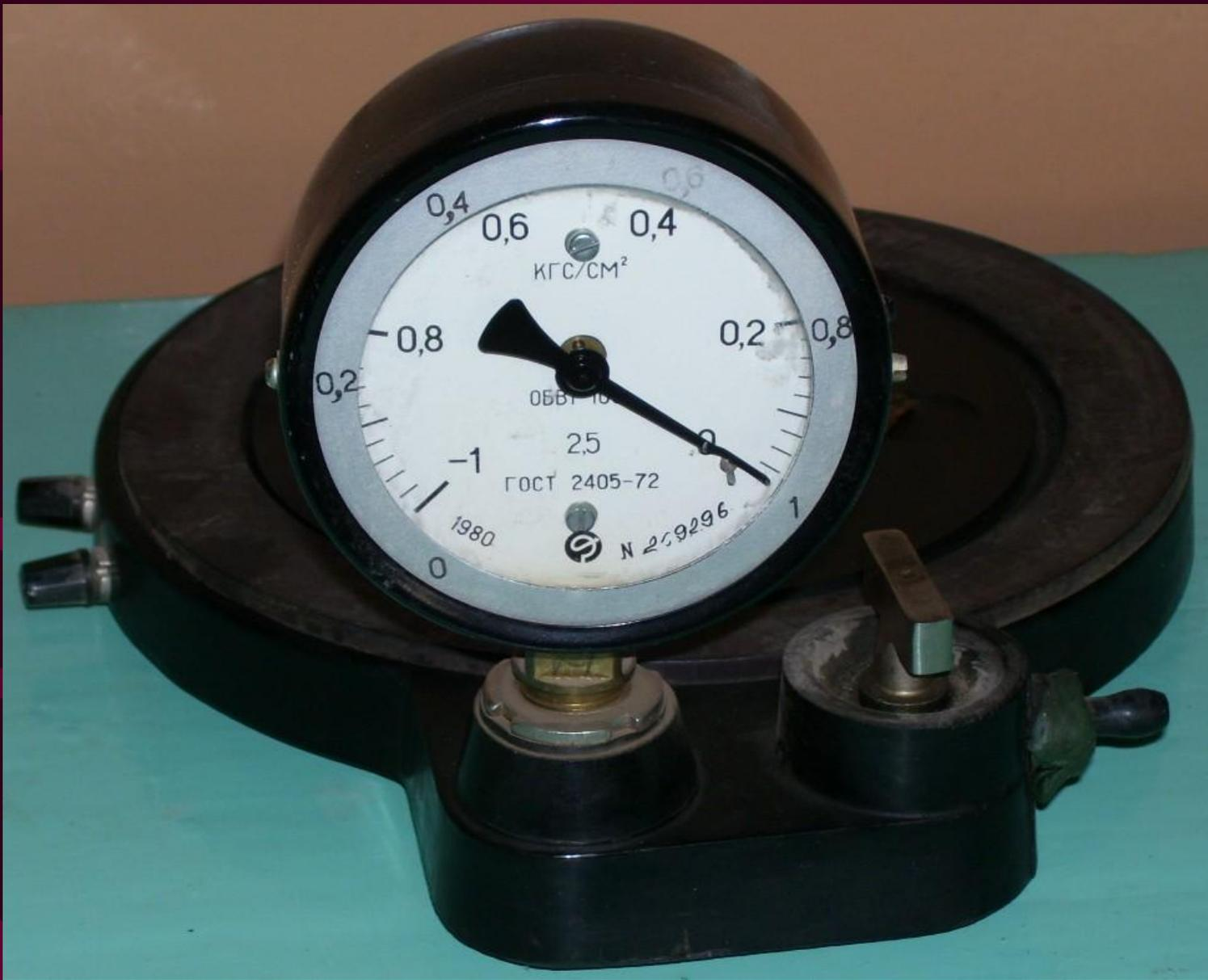
Здесь по манометру контролируют давление под стеклянным колоколом (не показан) при откачке из под него воздуха.
