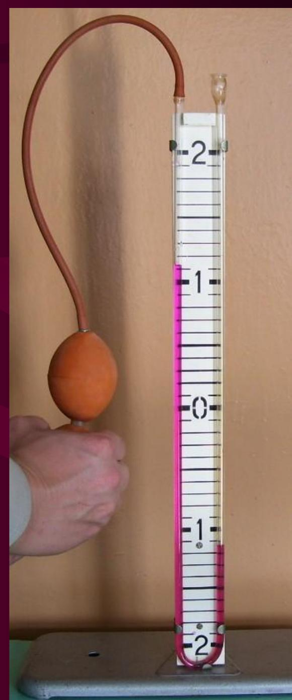
Соединим жидкостный манометр резиновой трубкой с плоской коробкой, одна сторона которой затянута резиновой плёнкой.
