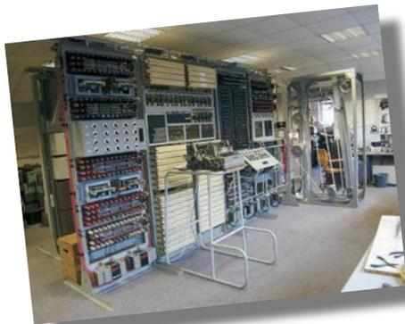
1942-1943 гг. В Англии при участии Алана Тьюринга была создана вычислительная машина "Colossus". В ней было уже 2000 электронных ламп. Машина предназначалась для расшифровки радиোগрамм германского Вермахта.
