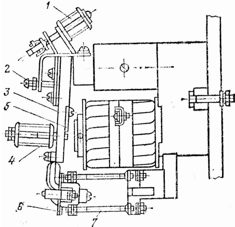
Рис. 4.44. Реле типа РЭВ-880;
