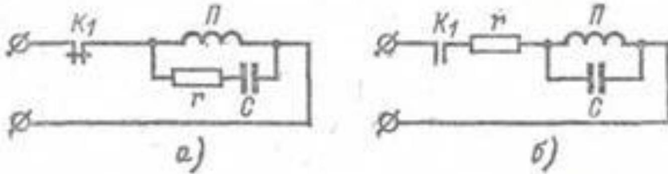
Рис. 2-19. Схема замедления действия промежуточных реле.
