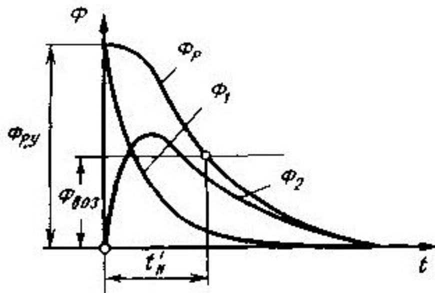
Рис. 2.17. Затухание магнитных потоков в магнитопроводе промежуточного реле замедленного действия при размыкании цепи его обмотки
