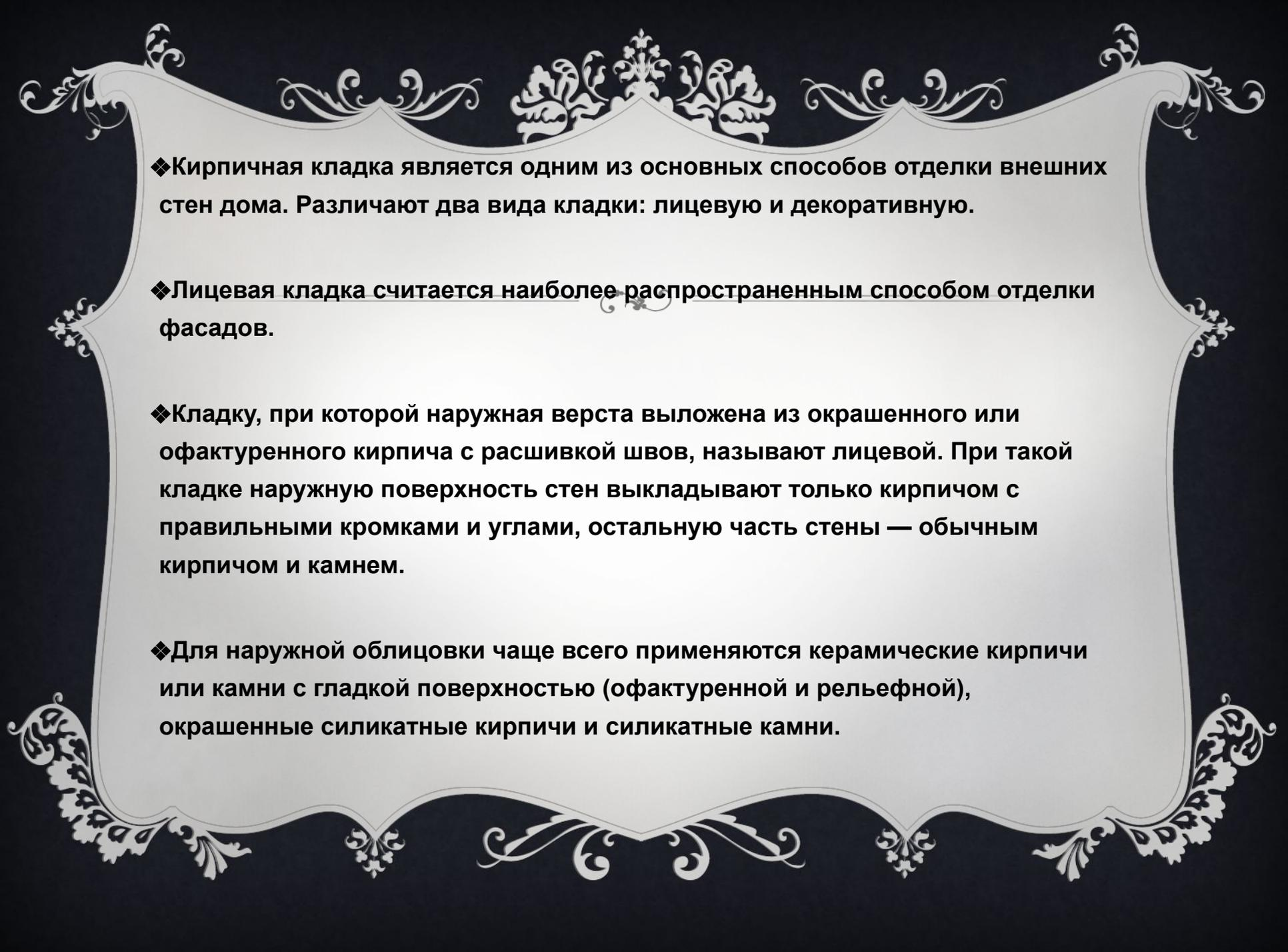
❖ Кирпичная кладка является одним из основных способов отделки внешних стен дома. Различают два вида кладки: лицевую и декоративную.
