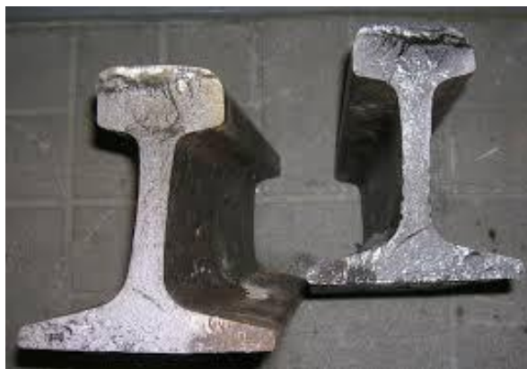
Рисунок – Износ рельсовых проводников
