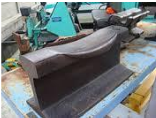
Рисунок – Износ рельсовых проводников
