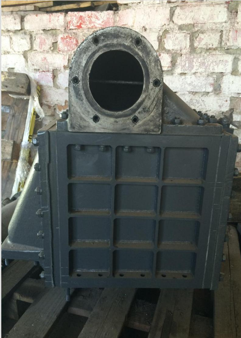
В эксплуатации охладители наддувочного воздуха периодически осматривают. При сливе масла из маслоулавливающих бачков или ресивера следят, нет ли в нем воды, которая может попадать в ресивер вместе с воздухом через трещины в трубках охладителя. При подозрении на утечки воды дальнейшая работа дизеля до выяснения причин не разрешается.
