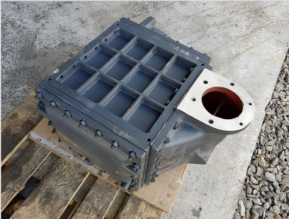
*Охладители (теплообменники) наддувочного воздуха.* Температура наддувочного воздуха дизеля оказывает большое влияние на его экономичность и надежность. Охлаждение наддувочного воздуха применяют для повышения мощности дизелей на единицу объема рабочего цилиндра, увеличения массы воздуха, подаваемого за рабочий цикл, и снижения средней температуры цикла.
