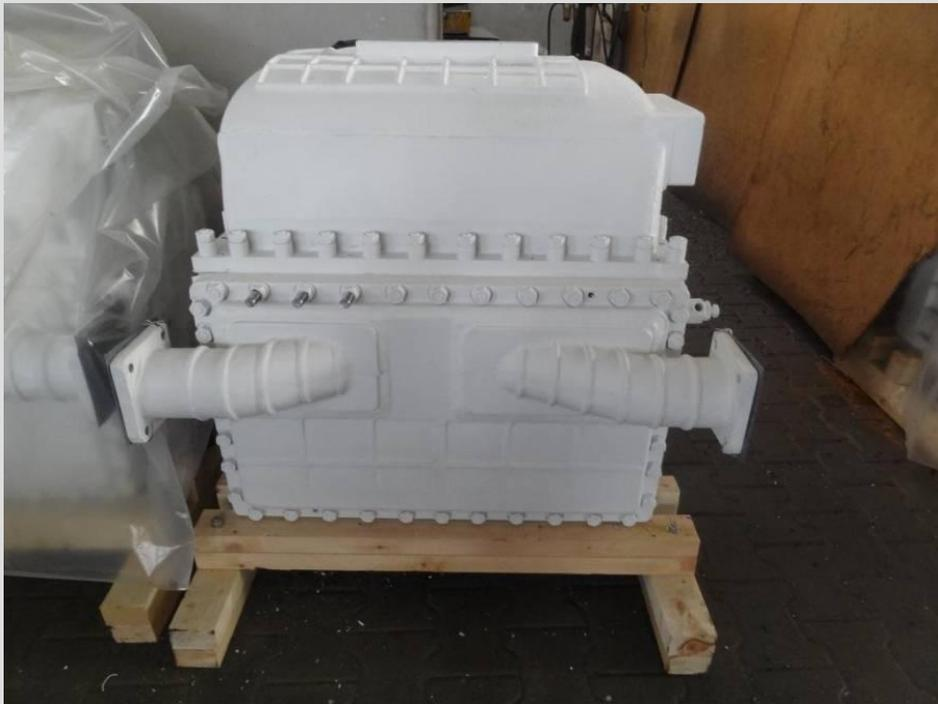
На серийных тепловозах наддувочный воздух охлаждается в водовоздушных теплообменниках, включенных в самостоятельный контур циркуляции охлаждающей воды или в контур воды, охлаждающей масло дизеля. Воздухоохладители, располагаемые обычно на дизеле, отличаются небольшими размерами и массой.
