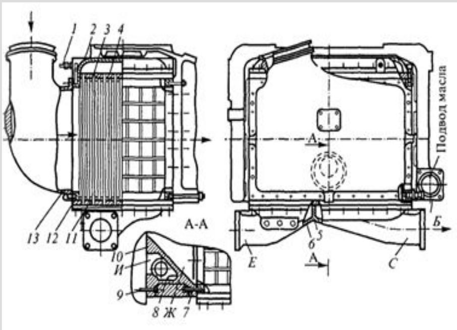
1 — трубка для отвода пара; 2 — верхняя крышка; 3 — трубка; 4, 11 — трубные доски; 5 — перегородка; 6 — нижняя крышка; 7 — шпилька; 8 — кронштейн; 9 — болт; 10 — резиновое кольцо; 12 — корпус; 13 — патрубок; Б — фланец; Е, С — патрубки; Ж, И — каналы.
