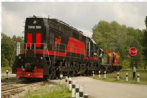
Двухдизельный маневровый восьмиосный тепловоз ТЭМ14 с электропередачей предназначен для тяжелой маневровой, вывозной, горочной и магистральной работы. За счет применения двухдизельной силовой установки и интеллектуального алгоритма ее управления ТЭМ14 обладает повышенными показателями энергоэффективности и экологичности:
