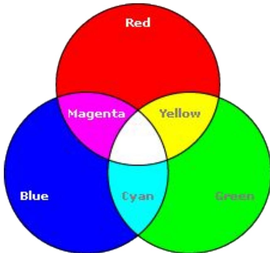
Так при глубине цвета в 24 бита на кодирование каждого из базовых цветов выделяется по 8 бит, тогда для каждого из цветов возможны  $N=2^8=256$  уровней интенсивности.
