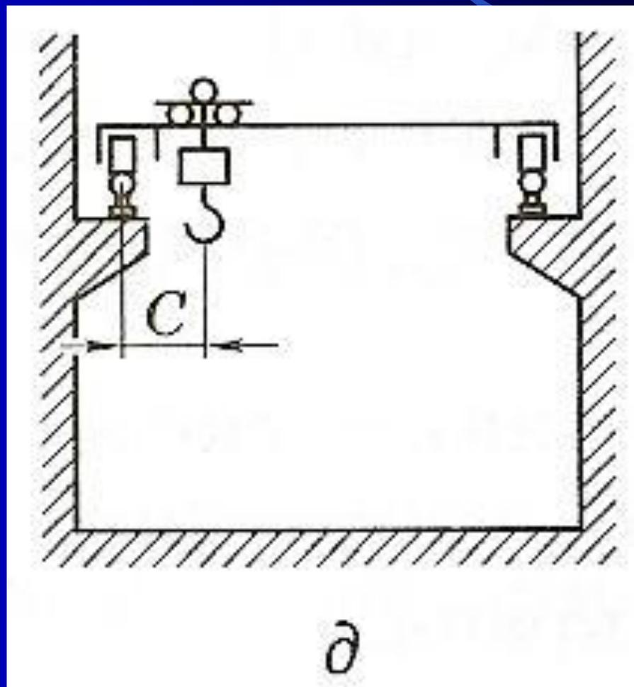
Вылет консоли ( $l$ , м) – наибольшее расстояние по горизонтали от оси ближайшей консоли опоры крана до оси расположенного на консоли грузозахватного органа;
