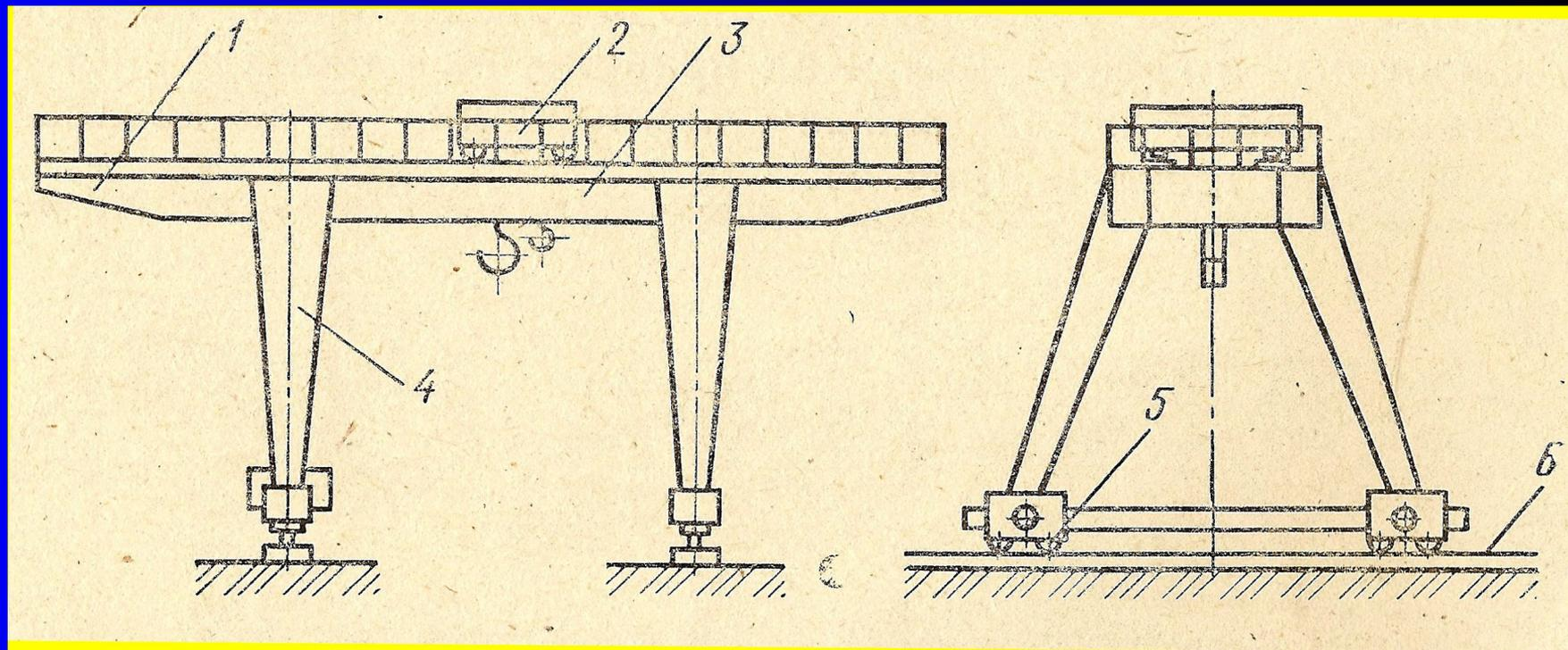
1 — консоли крана, 2 — грузовая тележка крана, 3 — мост, 4 — опорные стойки, 5 — ходовые тележки, 6 — крановый путь
