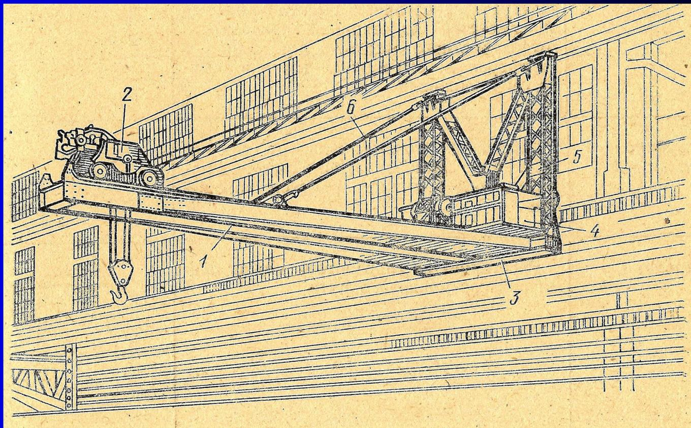
1 — главные балки полумоста, 2 — грузовая тележка, 3 —
