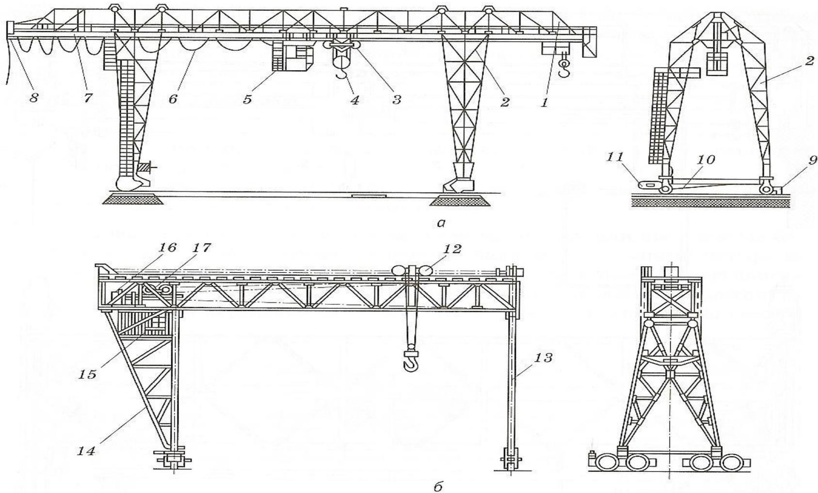
*а* – двухконсольный; *б* – бесконсольный; 1 – мост; 2, 13, 14 – опорные стойки; 3, 12 – грузовые тележки; 4 – крюковая подвеска; 5, 15 – кабины машиниста; 6 – токоподвод; 7, 16, 17 – лебедки; 8 – направляющий блок; 9 – ведомая ходовая тележка; 10 – стяжка; 11 – ведущая ходовая тележка
