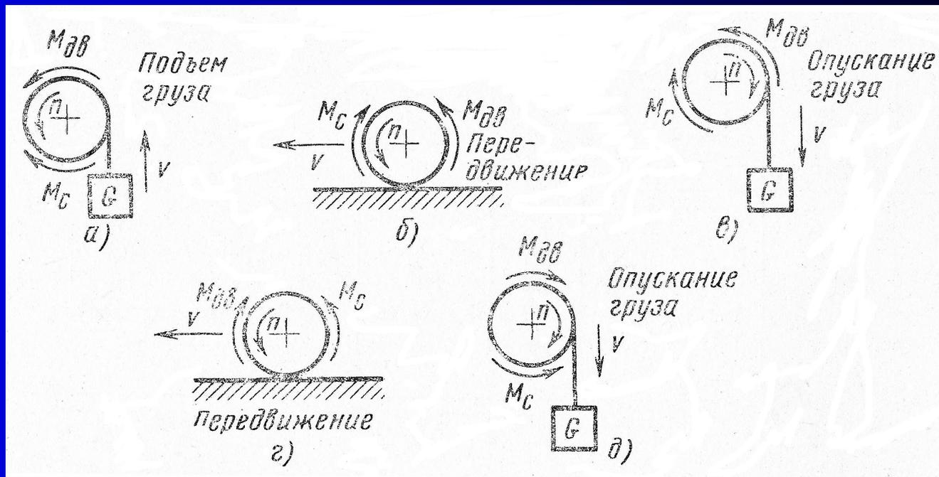
При *двигательном режиме* работы, когда двигатель преодолевает момент сил сопротивления  $M_c$  в механизме, крутящий момент на валу ротора  $M_{дв}$  направлен в сторону его вращения  $n$ , например, при подъеме груза или передвижения крана. В этом случае крутящий момент двигателя положителен, а момент сил сопротивления — отрицателен (рис. 7, а, б).
