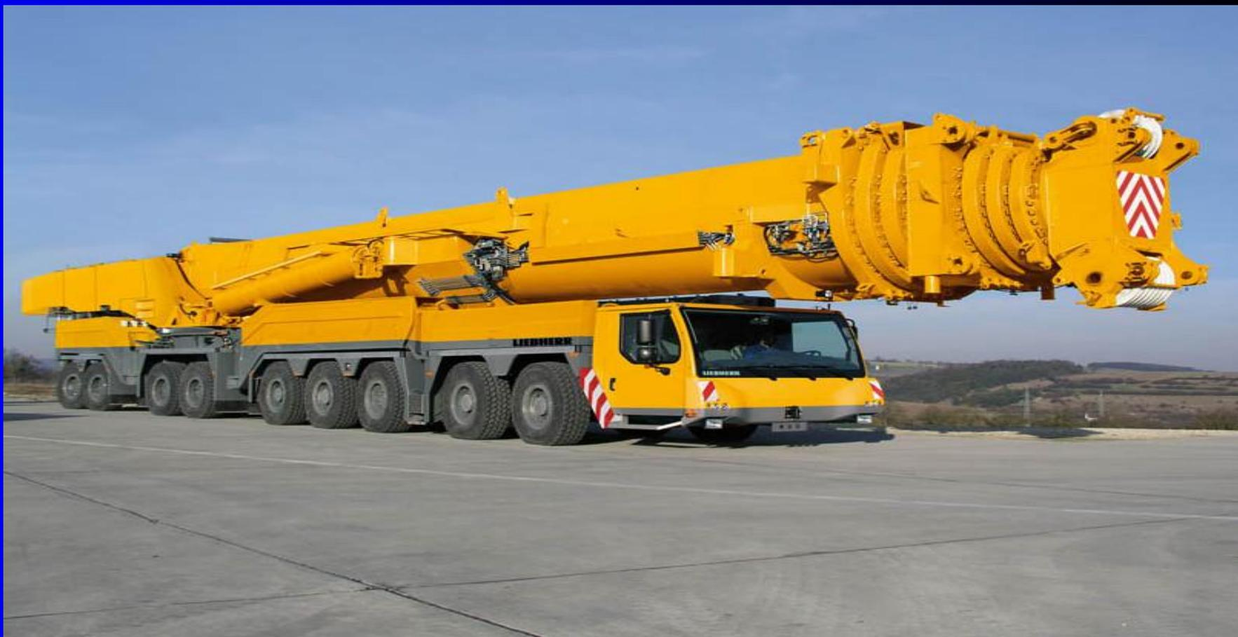
Самый большой гидравлический автокран. Грузоподъёмность 1200 тонн, вылет стрелы до 100 метров. В транспортном положении собственная длина почти 20 метров, колёсная формула - 18x18x8. Скорость на дороге - 75 км/ч, 12<sup>72</sup> передач вперёд, 2 назад.
