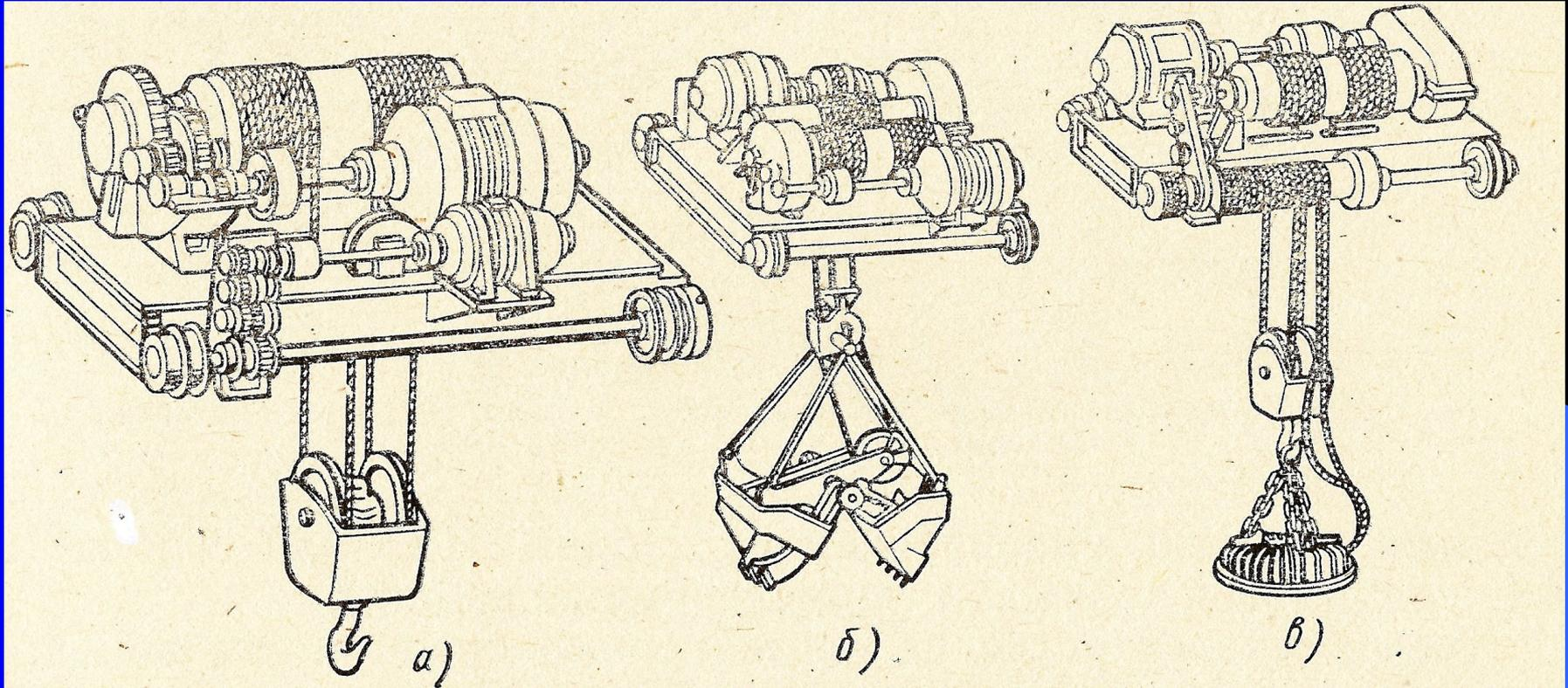
а — крюковой, б — грейферной, в — магнитной
