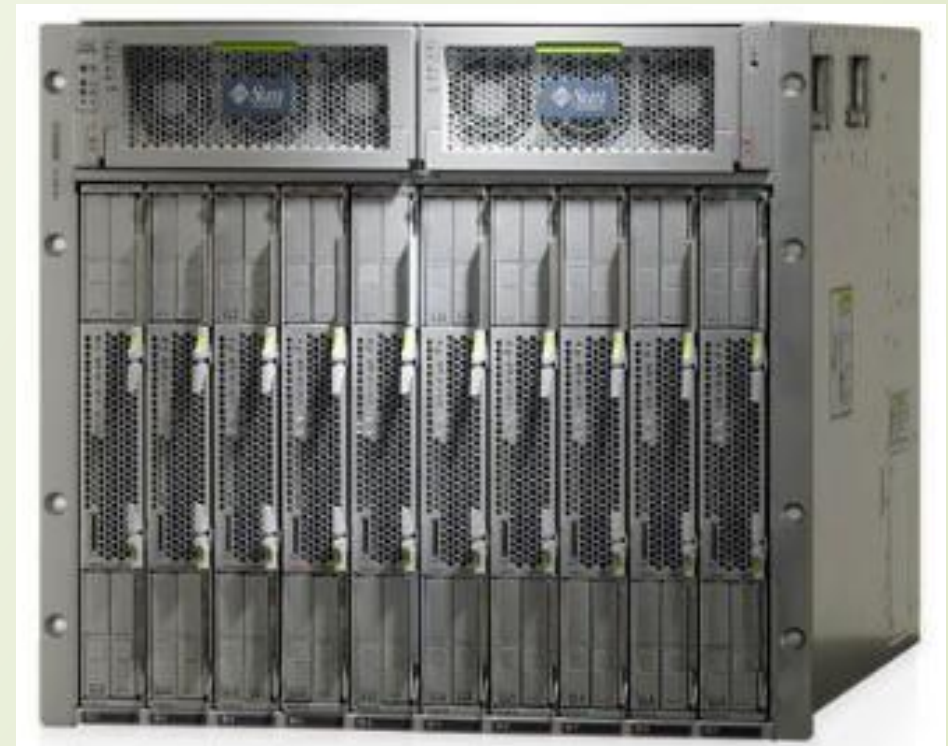
Рисунок 1. Типичный Blade-сервер (Sun Blade X6250)
