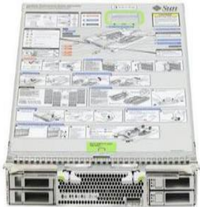
Рисунок 1. Типичный Blade-сервер (Sun Blade X6250)
