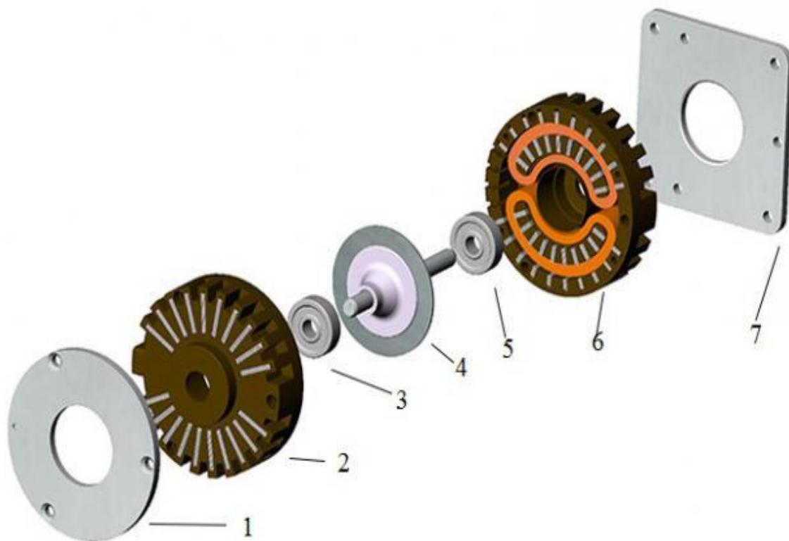
Двигатель состоит из следующих деталей: 1. Задняя часть корпуса. 2. Статор. 3. Подшипник. 4. Магнитный диск (ротор). 5. Подшипник. 6. Статор с обмоткой. 7. Передняя часть корпуса.
