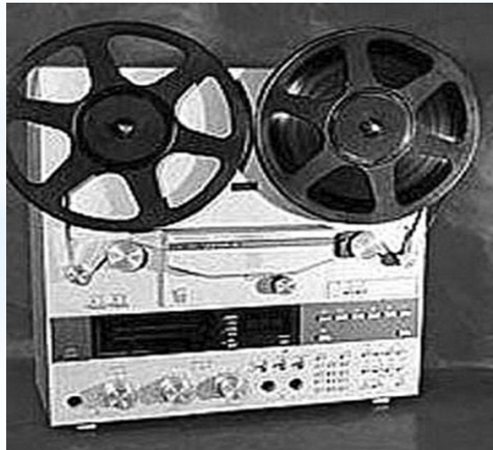
Рис.1. Катушечный магнитофон с магнитной лентой на катушках
