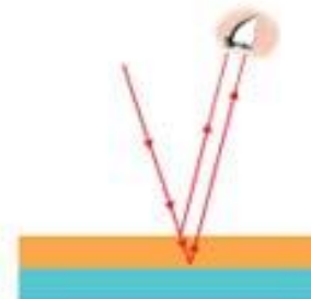
Схема хода лучей при интерференции в тонкой пленке
