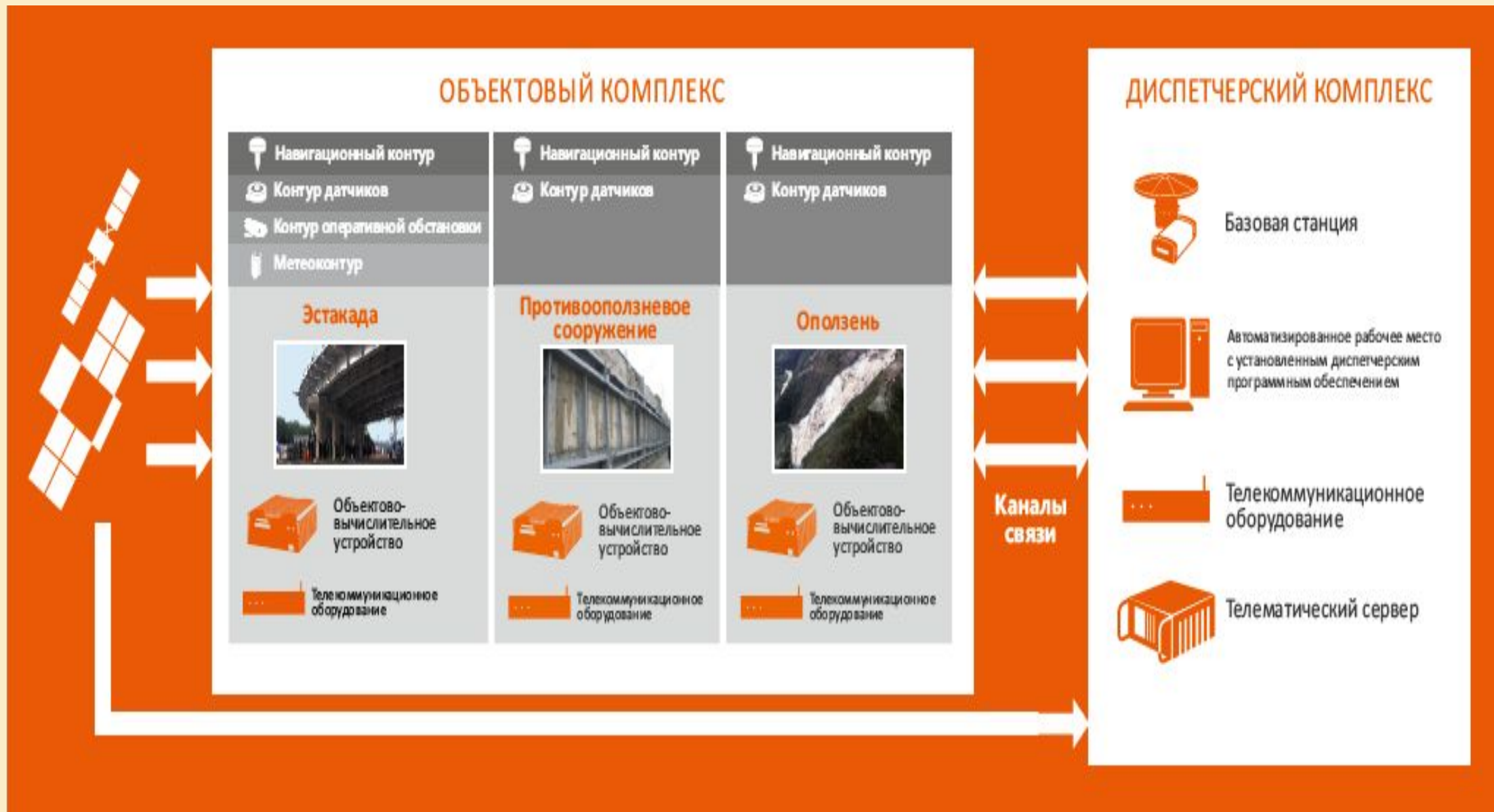
Схема системы контроля деформаций и смещений.
