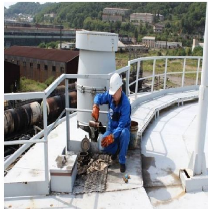
Отбор пробы из резервуара
