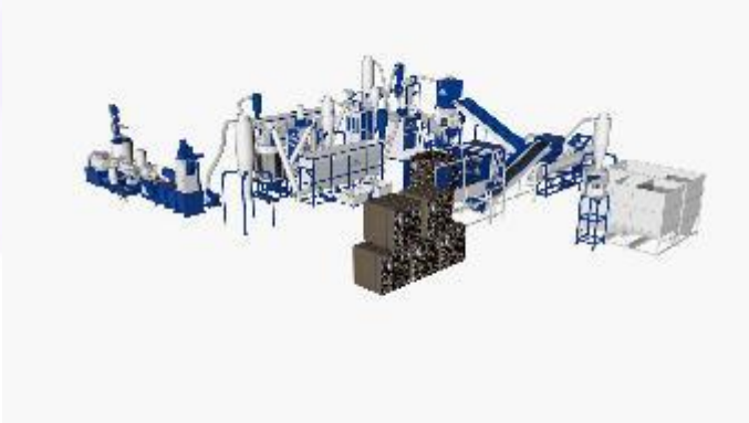
КОМПЛЕКС ДЛЯ ПЕРЕРАБОТКИ ПЭТ БУТЫЛКИ
