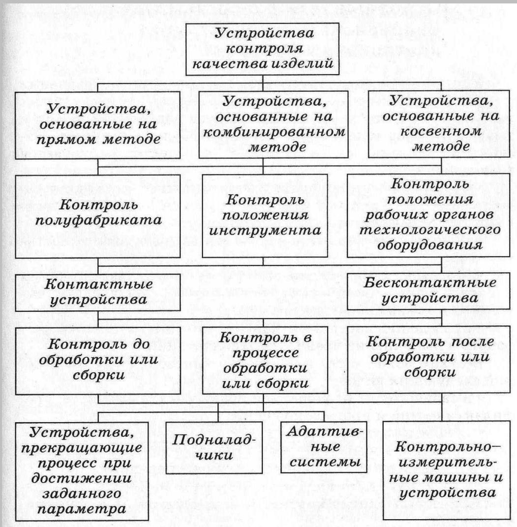
В качестве **автоматических контрольных средств** в автоматизированном поточном производстве применяют контрольно-сортировочные автоматы (КСА), а в ГПС — контрольно-измерительные машины (КИМ).
