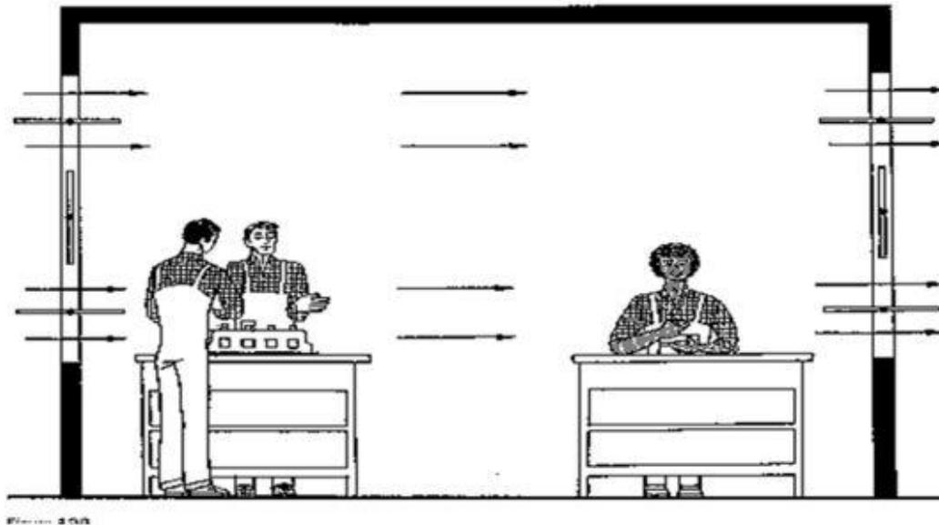
Естественная вентиляция с помощью регулируемых отверстий (проемов) в противоположных сторонах помещения.
