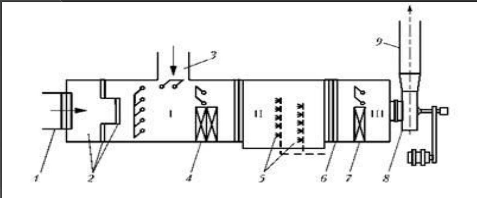
**1** - заборный воздуховод; **2** - фильтр; **3** - соединительный воздуховод; **4** - калорифер; **5** - форсунки увлажнителя воздуха; **6** - каплеуловитель; **7** - калорифер второй ступени; **8** - вентилятор; **9** - отводной воздуховод
