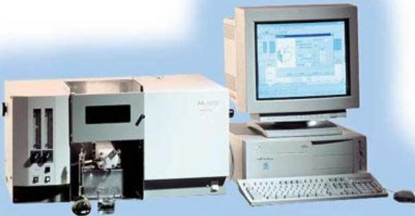
ААС – спектрометр для определения ртути RA - 915
