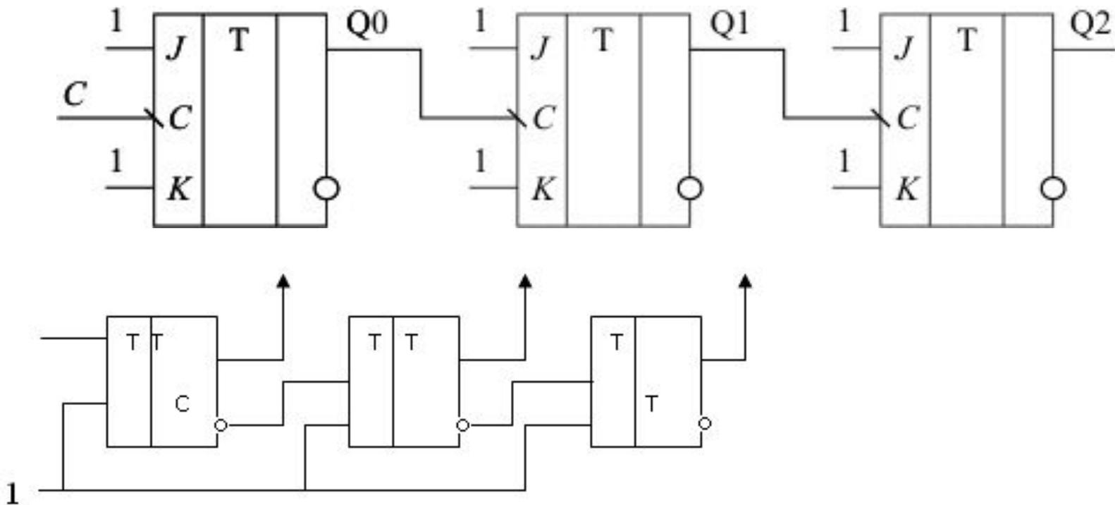
Счетные сигналы подаются на младший разряд счетчика, поэтому состояние счетчика определяется
