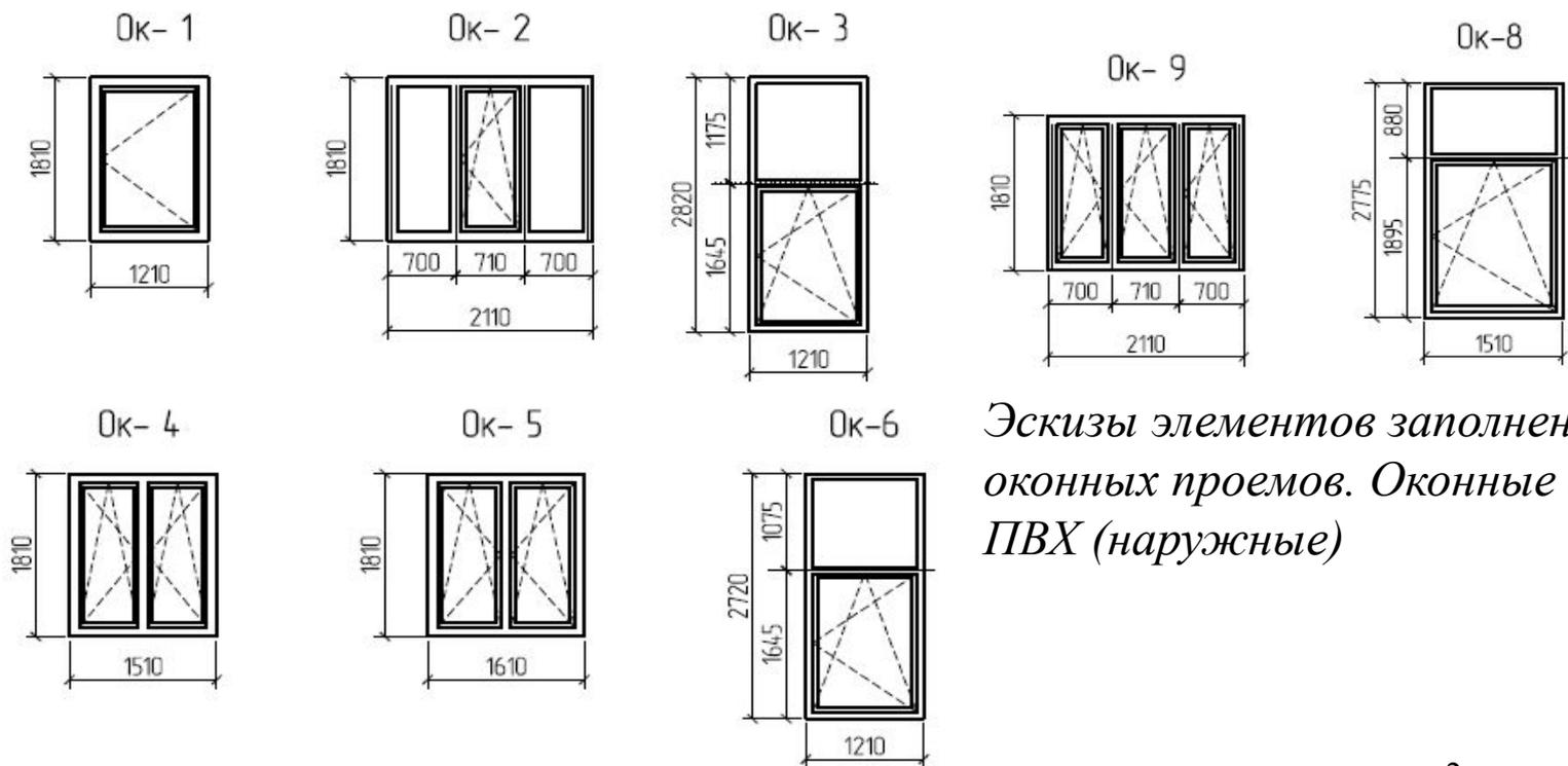
*Эскизы элементов заполнения оконных проемов. Оконные блоки из ПВХ (наружные)*
