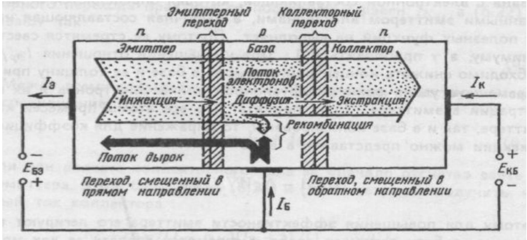
Схема движения электрических зарядов
